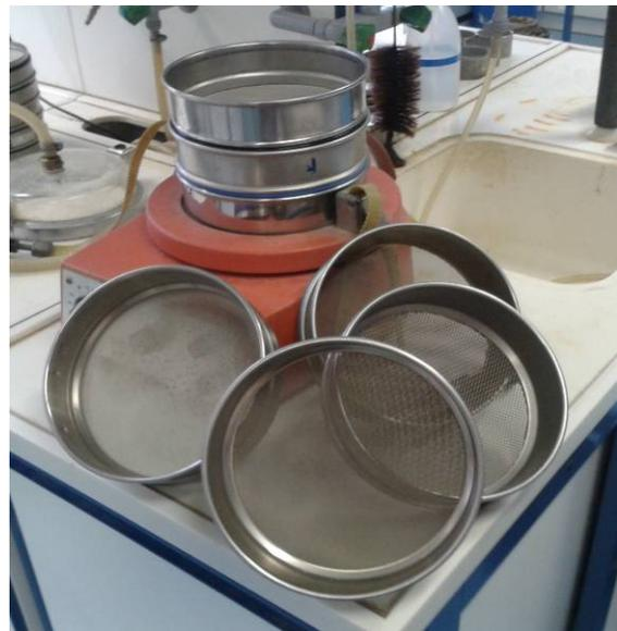
Abbildung 28: Siebe unterschiedlicher Maschenweite
