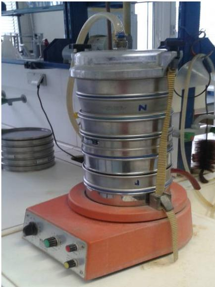
Abbildung 27: Nasssiebapparatur
