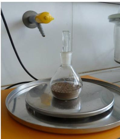
Abbildung 29: Pyknometer auf Waage
