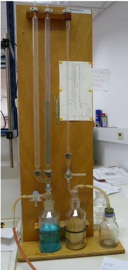
Das im Glas entstehende Kohlendioxid verdrängt eine äquivalente Menge Luft aus der Scheiblerbase. Diese (Luft) drückt gegen die Wassersäule im Messrohr. Der Wasserspiegel im Messrohr wird durch den Druck sinken, der im Aufspiegelrohr steigen. Nach Ausspiegeln der beiden Flüssigkeitshöhen kann auf dem Messrohr das verdrängte Volumen abgelesen werden. Diese wird mithilfe der Formel 16 in den prozentuellen Massenanteil des Kalks an der Bodeneinwaage umgelegt.
