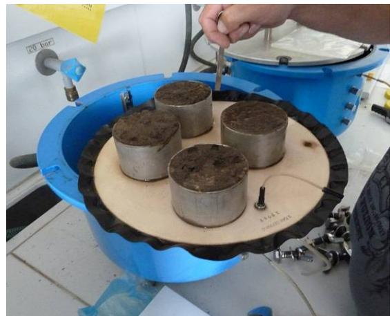
Abbildung 26: Drucktopf und Zylinder
