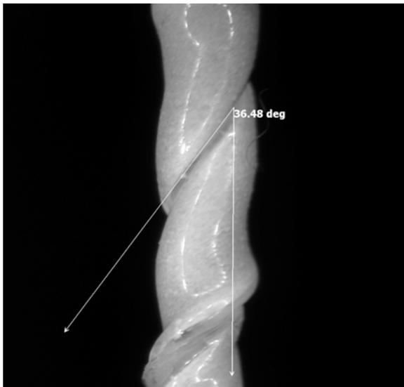
**Abbildung 23: Bemessung des Verdrehungswinkel bei einer verstreckt- verdrehten 2mm breiten Probe**
