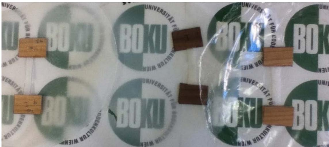
**Abbildung 15: Filme und Probenkörper mit unterschiedlichem Zellulosegehalt (1%, 10% und 50% von rechts nach links)**
