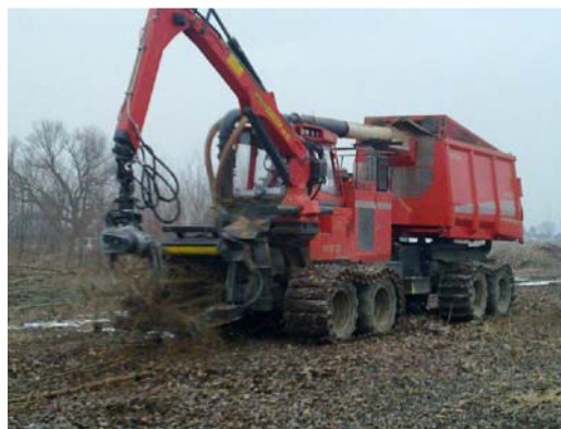
Abbildung 14: Mobiles Hackgerät mit Bunker für Hackgutzwischenlagerung; Quelle: Deim 2010
