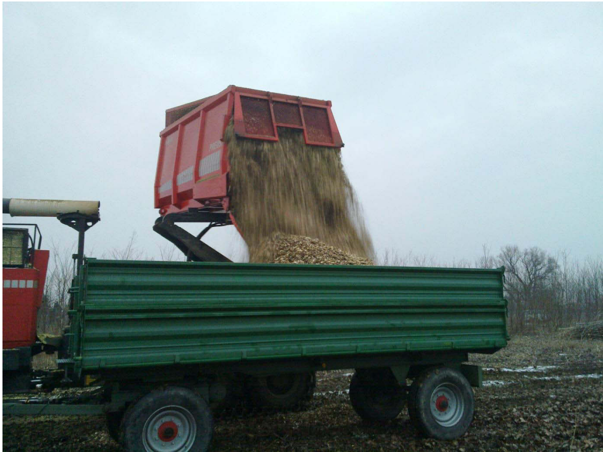
Abbildung 17: Überladung von mobilem Hackgerät mit Zwischenbunker auf einen landwirtschaftlichen Anhänger; Quelle: Deim 2010
