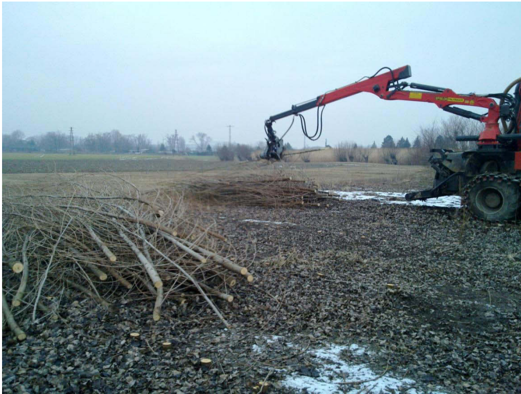
Abbildung 15: Mobiles Hackgerät bei der Zuführung der zuvor gefällten und zwischengelagerten Stämme; Quelle: Deim 2010
