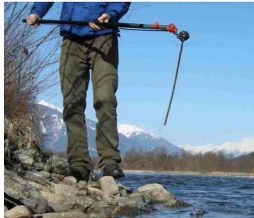
Abbildung 21: Einbaufertige Sonde mit Fitting und Gewindestange
