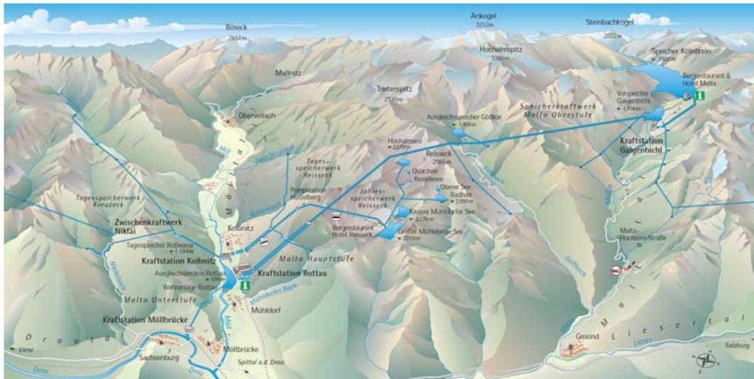
Abbildung 12: Systemskizze Kraftwerksgruppe Malta (Quelle: Verbund AG)
