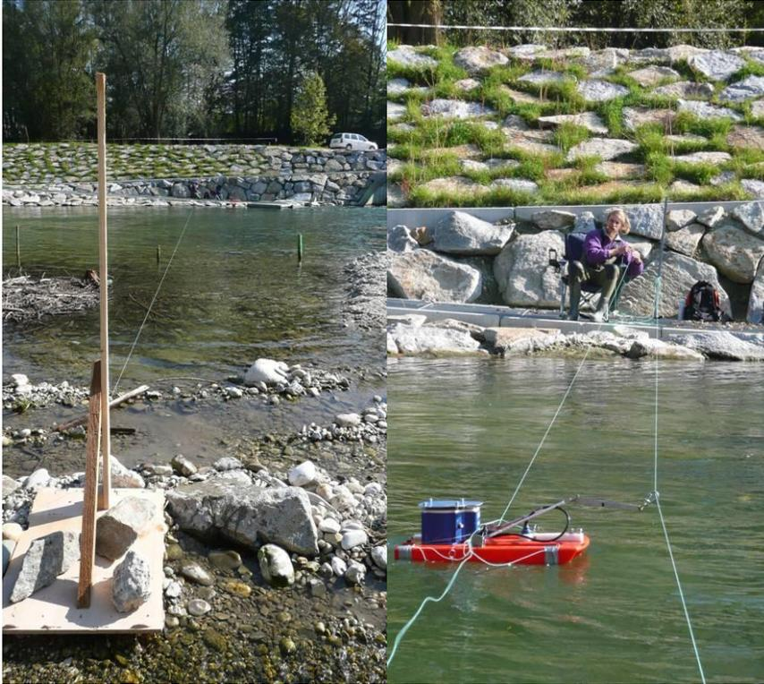
**Abb. 4-5: ADCP – Führungsvorrichtung für Messungen im Unterwasserbereich. Links Spannvorrichtung für die Führungsschnur, rechts ADCP im Einsatz.**
