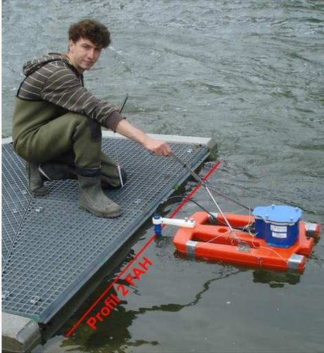
Abb. 4-6 ADCP- Profilmessung am unmittelbaren Einstiegsbereich, 11.06.2012
