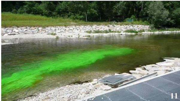
Abb. 5-21: Bildserie des Färbeversuchs bzw. Visualisierung der austretenden FMH – Strömung. Von links oben nach rechts unten (Bild 1 – Bild 11).
