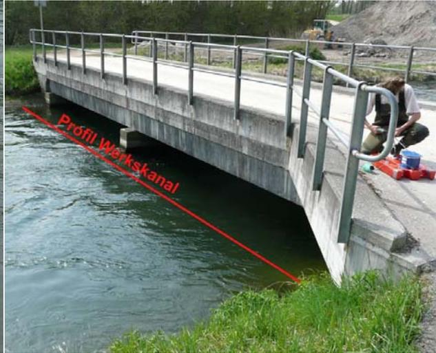
Abb. 4-7: Profil Werkskanal für die Durchflussmessung.
