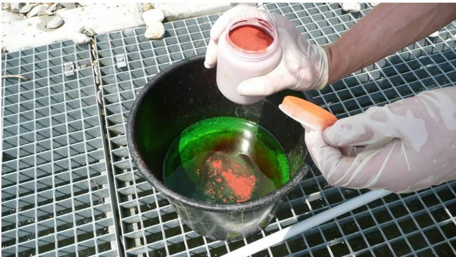
**Abb. 4-16: Uranin AP Färbemittel wird mit Wasser in einem Kübel angemischt.**
