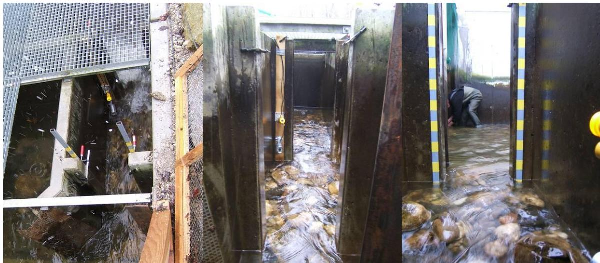
Abb. 4-23 Detailansichten des Multistrukturschlitzes 18 mit Kameraaufbau und Referenzlatten
