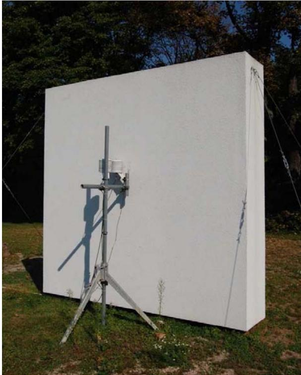
Abbildung 53: Referenzfläche – Mineralputzfassade im Versuchsgarten Wien Essling im September 2012.
