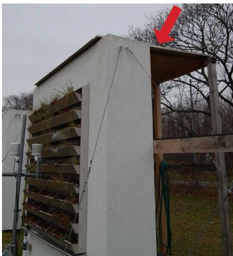
Abbildung 27: Vordachkonstruktion (roter Pfeil) über die Regenwasser in die oberste Pflanzwanne geleitet wird, Versuchsgarten Wien Essling im Oktober 2012.
