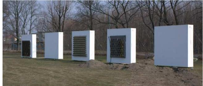
Abbildung 11: Versuchswände im Versuchsgarten in Wien Essling mit drei fassadengebundenen Begrünungssystemen und zwei Referenzfassaden, 2010 (Foto: IBLB).
