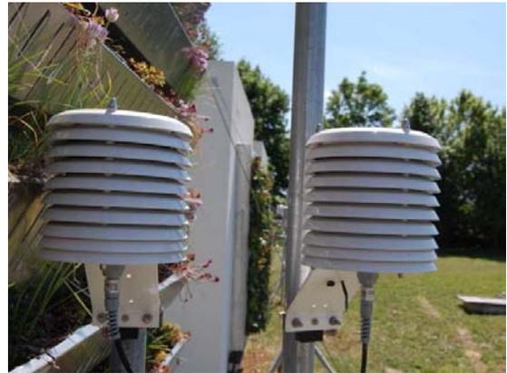
Abbildung 85: Lufttemperatur und Luftfeuchtigkeitssensoren in Lamellengehäuse aus Aluminium in 10 und 40 cm Abstand zu der Vegetationstragschicht der Systemwand im Versuchsgarten Wien Essling, Juni 2012.
