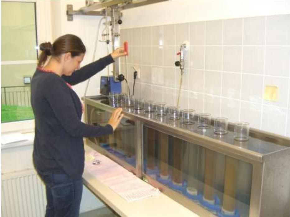
**Abbildung 9: Homogenisieren des Bodenmaterials in den Standzylindern**
