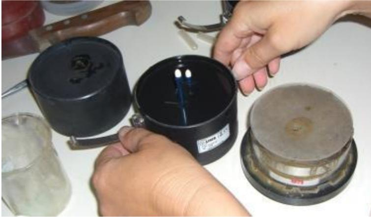
**Abbildung 13: HYPROP-Messkopf samt Saugkerzen und vorbereitete Zylinderprobe**
