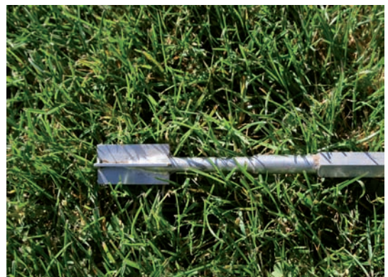
Abb. 17: Flügelkreuz der Sonde, 40 x 10 mm
