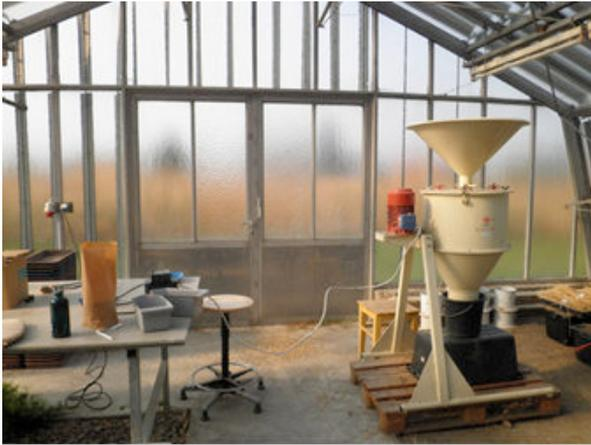
**Abbildung 20:** Fliehkraftschäler
