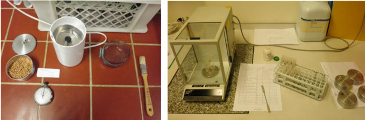
**Abbildung 6:** Kaffeemühle mit der zu vermahlenden Probe (links), sowie Waage mit Probenröhrchen und Mehlschalen (rechts)
