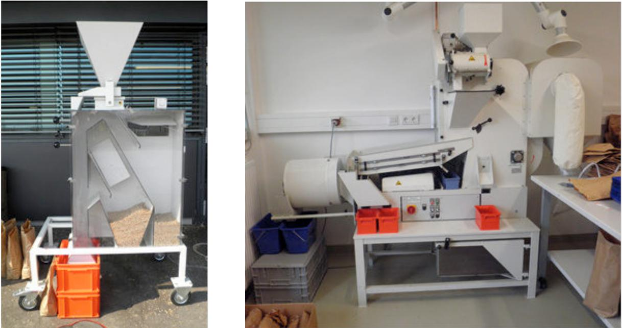
**Abbildung 5:** Saugluft-Stufensichter zur Trennung von Korn und Spreu (links), Siebmaschine zur Fraktionierung nach Korngröße (rechts)
