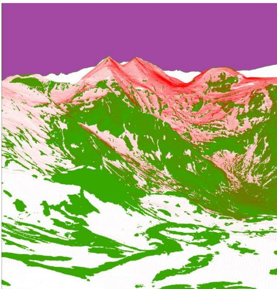
**Abbildung 24:** Überlagerung des Bildes mit dem transformierten und skalierten DGM. Jeder rote Punkt entspricht einer Rasterzelle des DGM mit 5m Auflösung.
