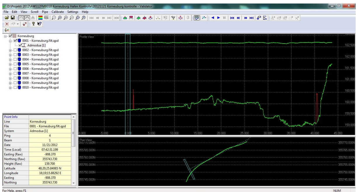
Abb.: 35 Auswertung der Singlebeam-Messung mit Quinsy, Korneuburger Hafen
