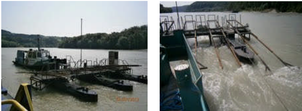
Abb.: 1 Peilrahmengestell am Boot montiert (GHS, 2013)
