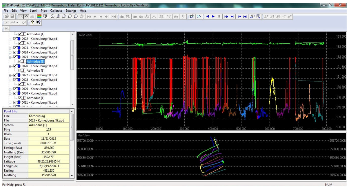
Abb.: 39 Auswertung der Singlebeam-Messung mit Quinsy, Korneuburger Hafen
