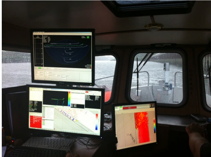
Abb.: 28 Darstellung der Multibeam-Messung an Bord mit Qinsy und Multibeam-Software
