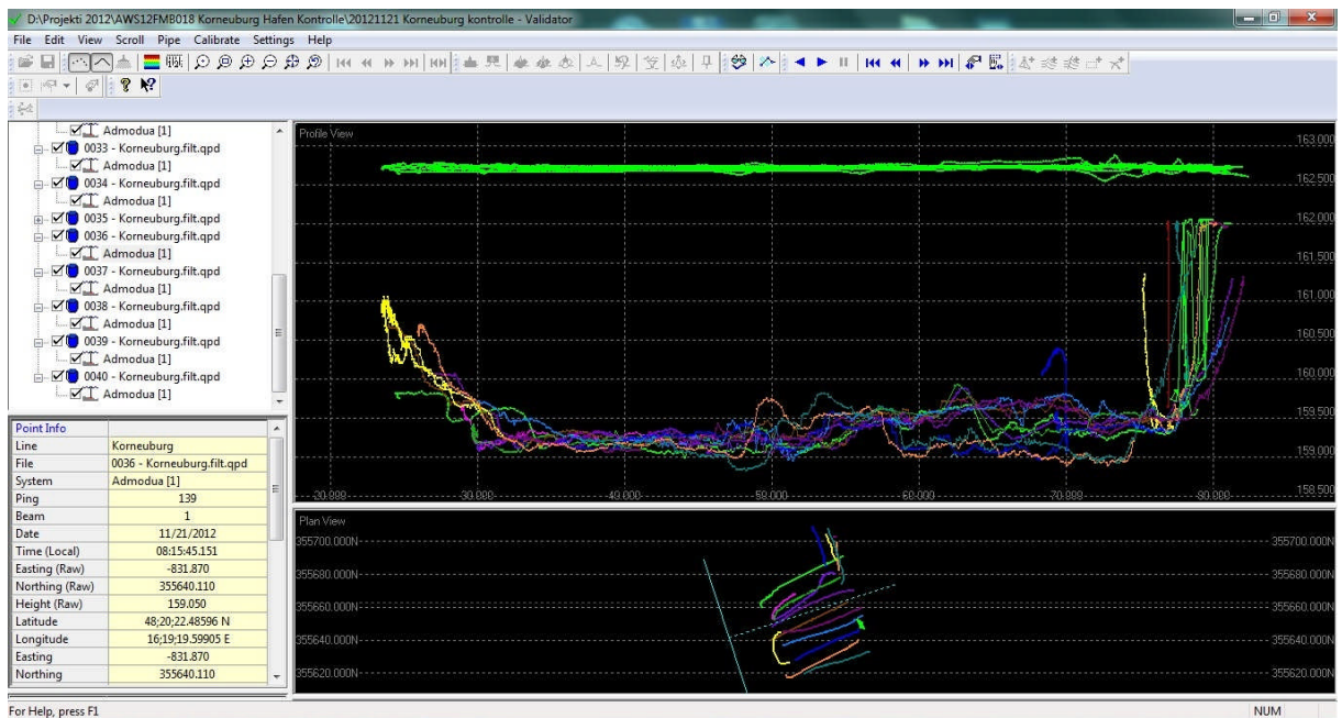
Abb.: 40 Auswertung der Singlebeam-Messung mit Quinsy, Korneuburger Hafen
