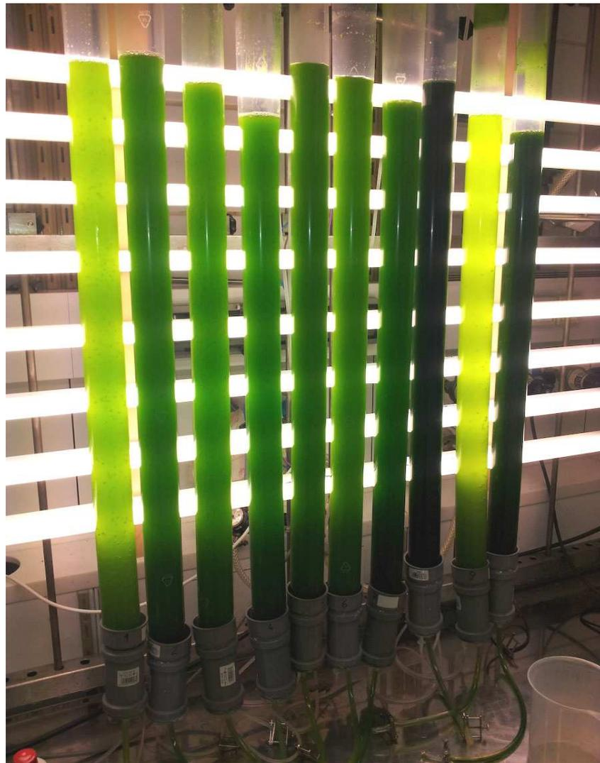
**Abbildung 52: Der in dieser Arbeit entwickelte Photobioreaktor produziert Algenbiomasse. Polyethylen Schlauchfolien sind kostengünstig und leicht zu beschaffen. 8 Leuchtstoffröhren sorgen für eine starke Beleuchtung.**
