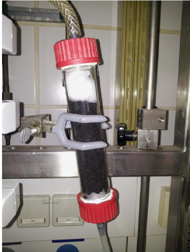
**Abbildung 18: Der Aktivkohlefilter dient der Reinigung der Druckluft, in der unerwünschte Substanzen wie Kohlenwasserstoffe aus dem Kompressor enthalten sein können.**
