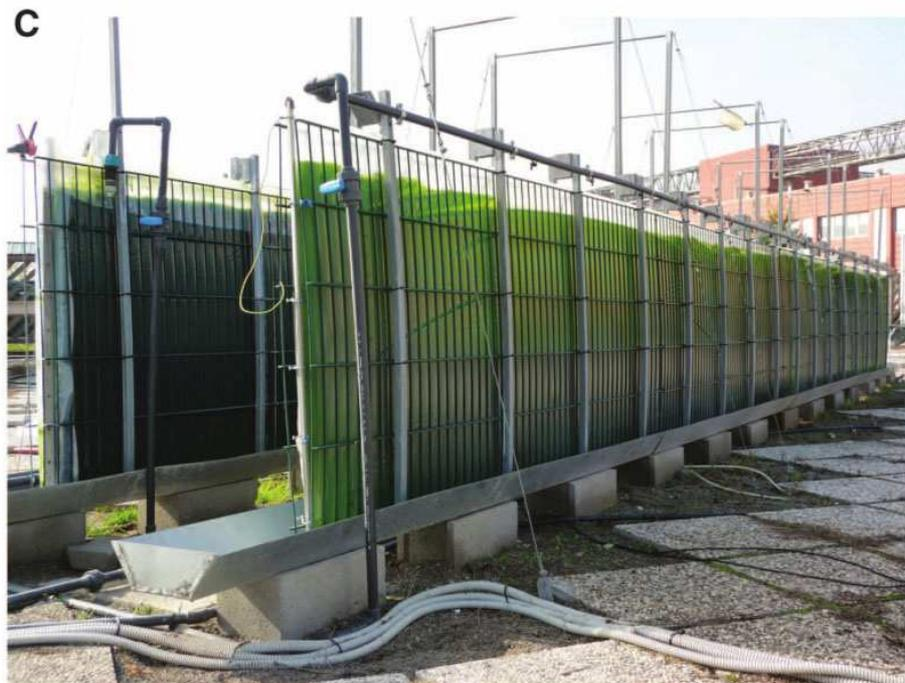
**Abbildung 51: Der "Green Wall Panel" Photobioreaktor an der Universität Florenz. (Quelle: Wijffels et al., 2009)**
