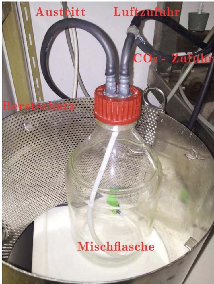
**Abbildung 19: Mischflasche mit Berstschutz. Die Mischflasche, in dieser Abbildung leer, wird zur Befeuchtung mit Wasser befüllt.**
