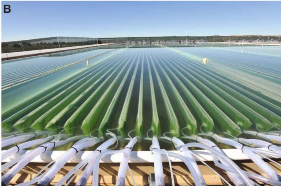
**Abbildung 50: Photobioreaktoren von Solix Biofuels zur Massenkultivierung von Algen. Die Reaktoren liegen unter Wasser und ähneln dem System von Proviron. (Quelle: Wijffels et al., 2009)**
