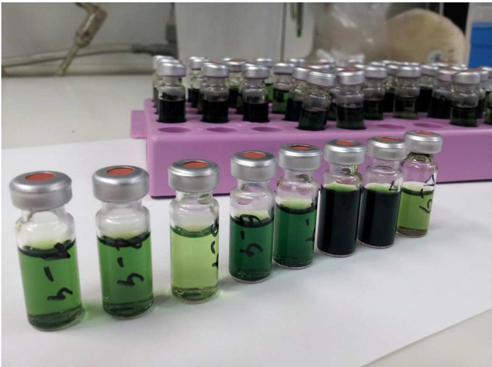
**Abbildung 21: Hydrolysierte Algenbiomasse zur Messung der Glucose auf der HPLC**
