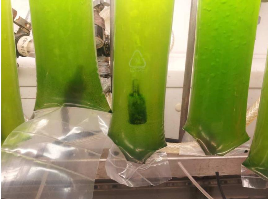
**Abbildung 17: Das untere Ende der Schlauchreaktoren wird verschweißt. Am Ende des Gasschlauchs befindet sich eine Gasfritte.**
