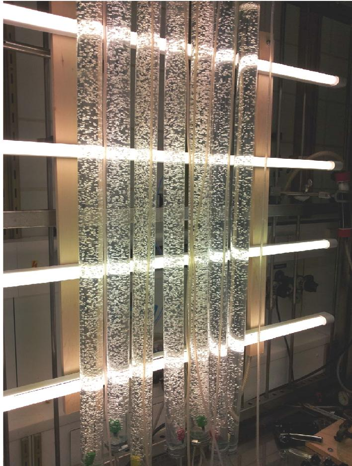
**Abbildung 16: Photobioreaktor im Testlauf ohne Algen. Gut sichtbar sind die aufsteigenden Gasblasen.**
