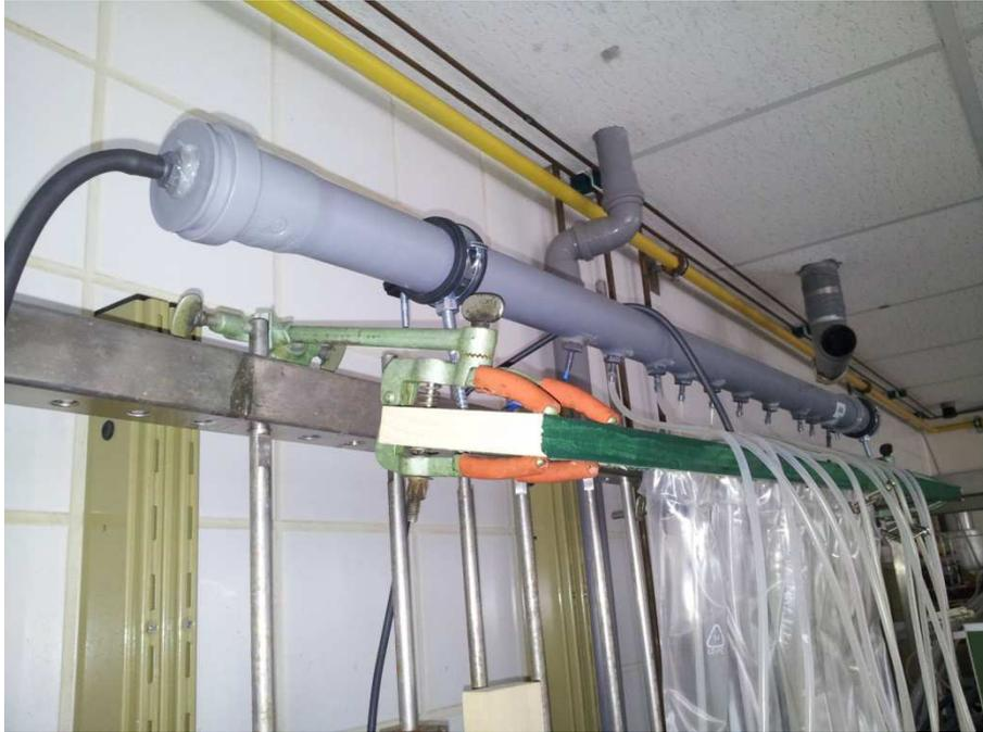
**Abbildung 20: Gasverteilungssystem. An der Unterseite des PP-Rohres sind Gasstutzen montiert. Von diesen führen die Gasschläuche zu den einzelnen Schlauchreaktoren.**
