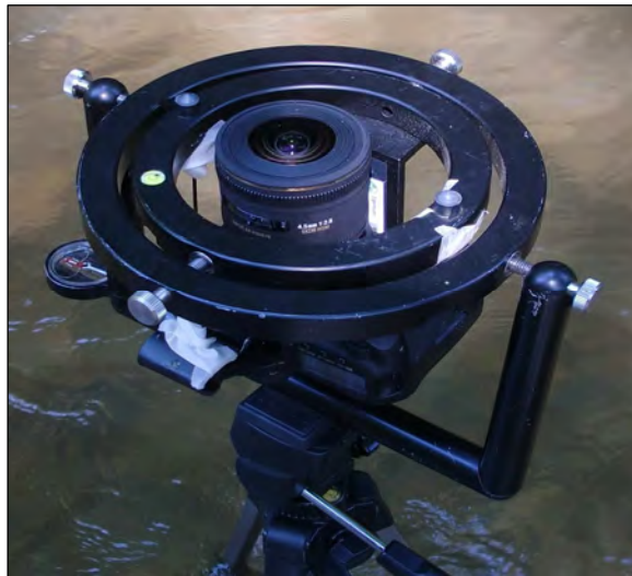
Abbildung 31: Fischaugenkamera mit kardanischer Aufhängung; 02.07.2013
