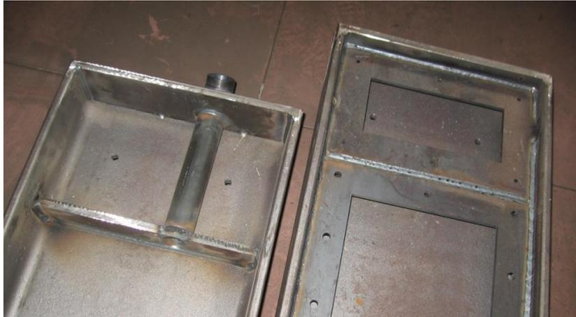
**Abb.:5** Foto: Korpus des Geophonmessbalkens. Links: der Korpus mit Rohrstützen als Kabeldurchführung vom Stegblech zum Abschlussdeckel. Rechts: ein verschlossenes Seitenende, die Auflagebleche sind bereits verschweißt (Quelle: eigene 2013)
