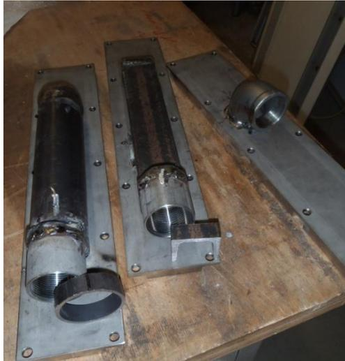
**Abb.:19** Foto - der untersuchten Befestigungsmöglichkeiten des Hydrophones : links Variante 1, mittig Variante 2, rechts Variante 3 (Quelle: eigene 2013)
