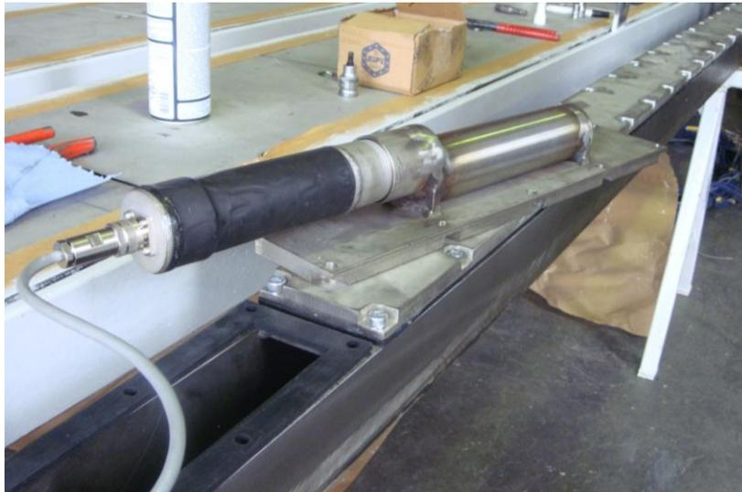
**Abb.:13** Foto - Hydrophonmesszelle Vormontage (Quelle: eigene 2013)
