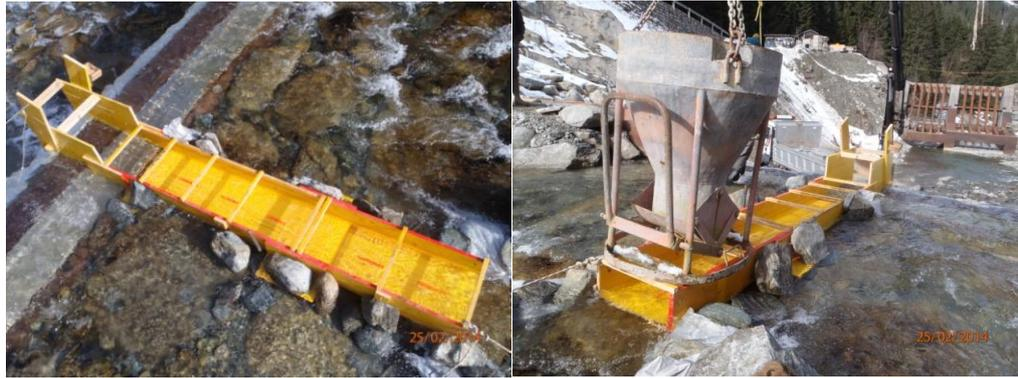
**Abb.:25** Foto - Versuchsrinne: Links Draufsicht, rechts Versuchsrinne mit Geschiebezugabeeinrichtung (Quelle: eigene 2014)
