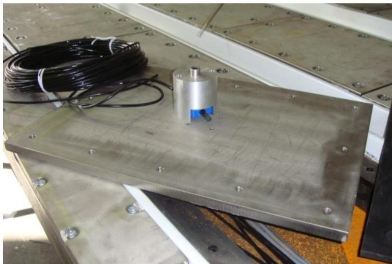
**Abb.:8** Foto - Komponenten der Geophonmesszelle: Messplatte ( Abschlussdeckel), Adapter und Sensor (Quelle: eigene 2013)
