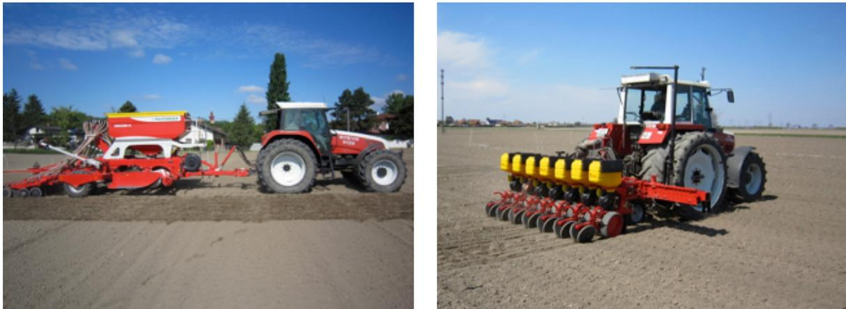
Abbildung 4 Anbaugespanne: Steyr 9125 mit Pöttinger Terrasem R3 und Steyr 8080 (Zugfahrzeug beim Versuchsanbau: MF 5430) mit Maternacc MS 8230.
