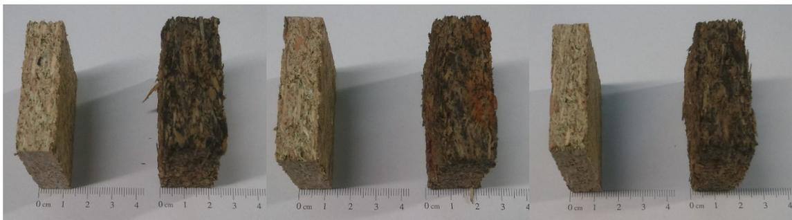
**Abb. 18** Zyklustest CNC1% **Abb. 19** Zyklustest CNC2% **Abb. 20** Zyklustest CNC3%
