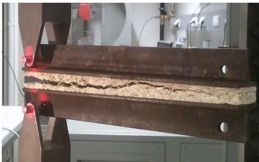
**Abb. 12** Laufende Bruchenergieprüfung mit Laserextensometer
