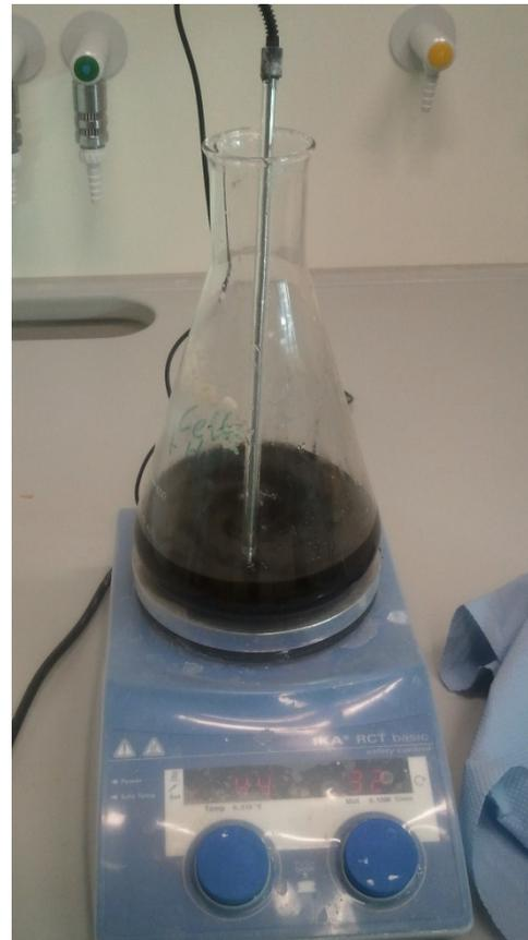
**Abb. 8** Reaktionslösung aus MCC mit 64%iger Schwefelsäure. Zellulose : Säure Verhältnis 9,1
