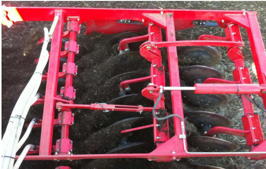
Abbildung 8: : Integrierte Scheibenegge mit anschließender Düngerablage bei der TERRASEM C6 fertilizer.
