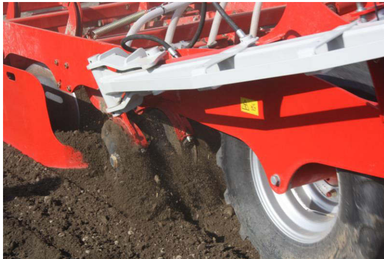
Abbildung 10: Dual Disc Exaktschar zur Düngerablage vor der Rückverfestigung des Saatbetts durch den Reifenpacker.
