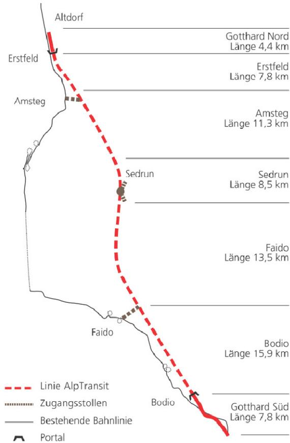
Abb. 51: Linienführung und Teilabschnitte des Gotthard Basistunnels, aus [16, S.13]
