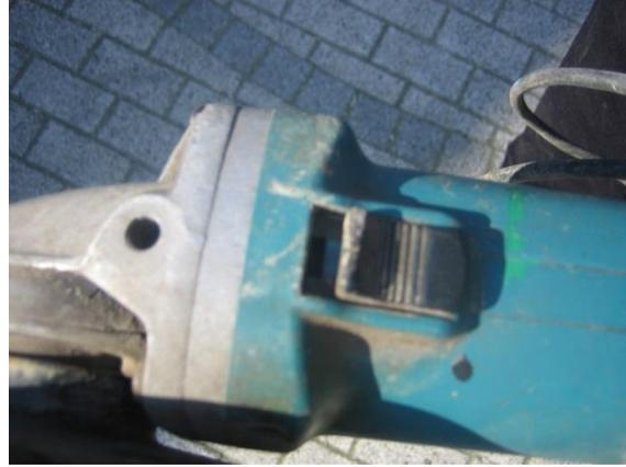
**Bild 2: Nicht dauerhaft zu haltender Schalter (seitlich)**
