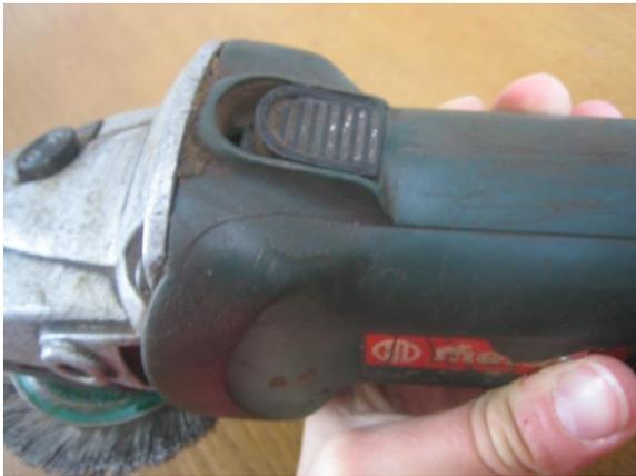
**Bild 9: Nicht dauerhaft zu haltender Schalter
