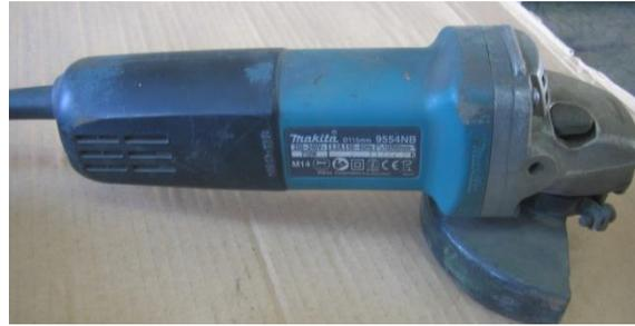
**Bild 4: Einhandwinkelschleifer**
