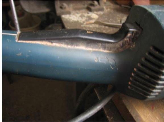
**Bild 8: Dauerhaft zu haltender Schalter**
