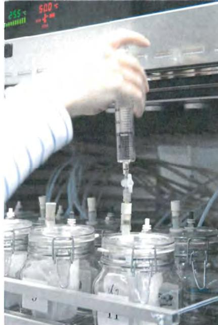
**Abbildung 4-5: manuelle Gasprobenentnahme (Foto: E. Pfeffer)**
