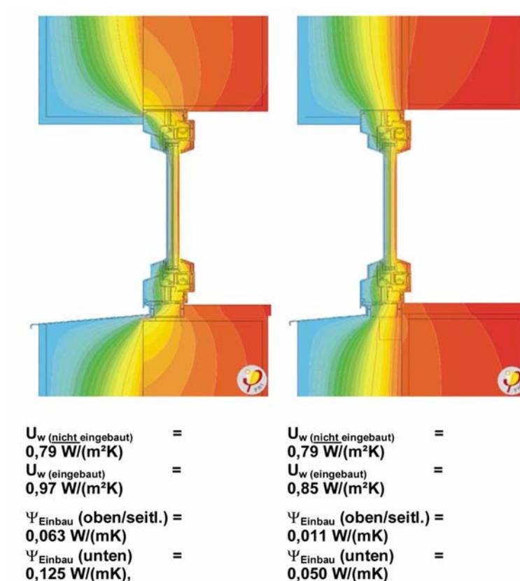
Abb. 5 Die Abbildung zeigt, dass beim Einbau neuer dichter Fenster ohne gleichzeitige Fassadendämmung u.U. mit Schimmelbildung zu rechnen ist. [26]
