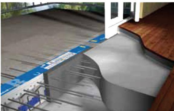
Stahlbeton-Stahlbeton Anschluss: Isokorb® Typ RK.
