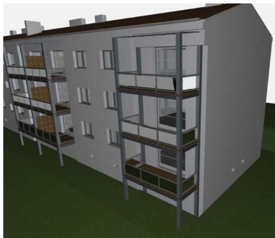
Abb. 84 Konstruktion der freistehenden Balkonkonstruktion [Quelle: eigene Darstellung]
