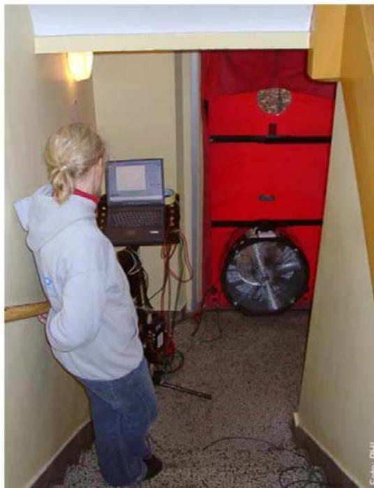
Abb. 11 Durchführung eines Drucktests mittels Blower-Door [38]
