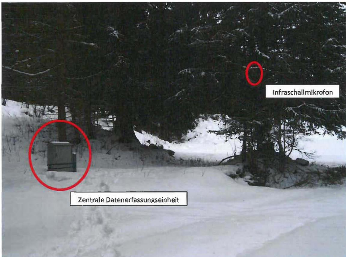
Abbildung 17: Die zentrale Datenerfassungseinheit sowie Position eines der Infrasschallmikrofone - ARFANG
