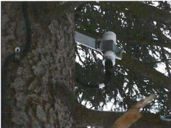
Abbildung 16: Infrasondmikrofon - ARFANG
