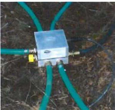
Abbildung 19: Das Sensorarray mit den 6 Gummischläuchen, welche die Schallwellen zu den Mikrofonen leiten – AVALANCHE SENTRY (aus Egli, 2006)
