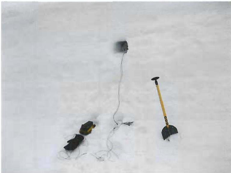
**Abbildung 94: Horizontale Schneelöcher – Messung Abschirmung von Mikrowellen durch Schnee**
