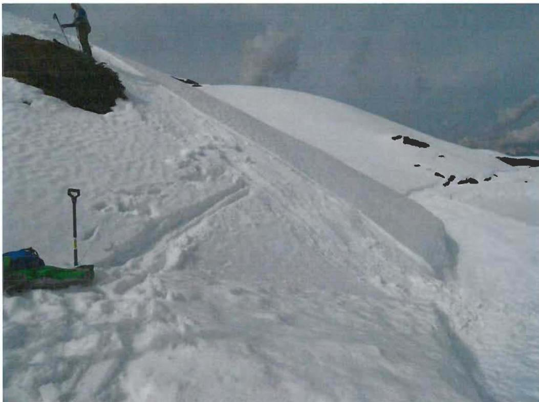
Abbildung 66: Vergrabenes Mikrofon nach künstlich ausgelöstem Schneerutsch
