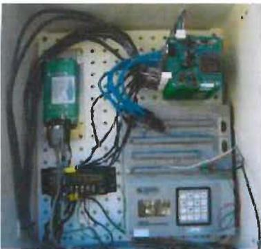
Abbildung 18: Die zentrale Elektronikeinheit – AVALANCHE SENTRY (aus Egli, 2006)
