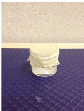
**Abbildung 16 Mit Folie verschlossenes Gefäß zur Messung der WVP**
