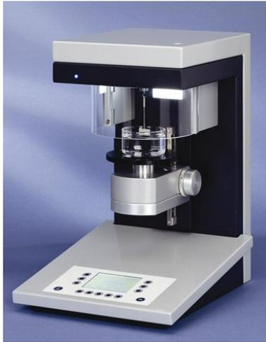
Abbildung 12 Tensiometer der Firma KRÜSS GmbH
