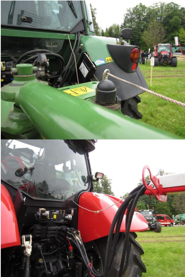
**Abbildung 10: Seilzug vom Traktor aus bedienbar**
