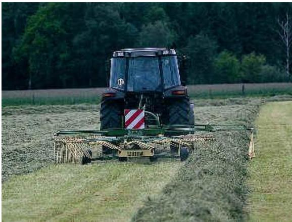
**Abbildung 2: Kreiselschwader<sup>2</sup>**
