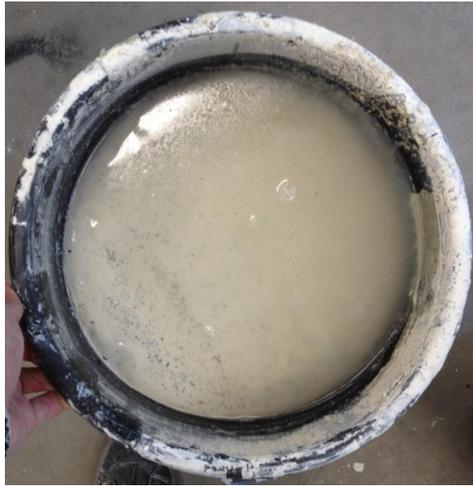
Abbildung 19: Kaolinit  $C_{v,f}=0,21$ .
