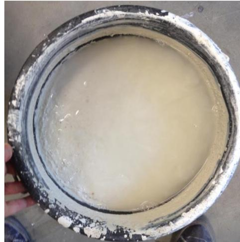
Abbildung 20: Kaolinit  $C_{v,f}=0,26$ .
