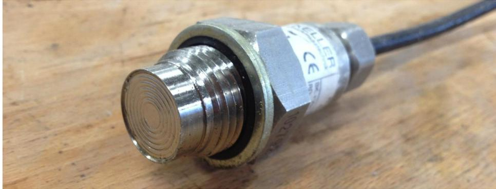
Abbildung 13: Drucksensor.
