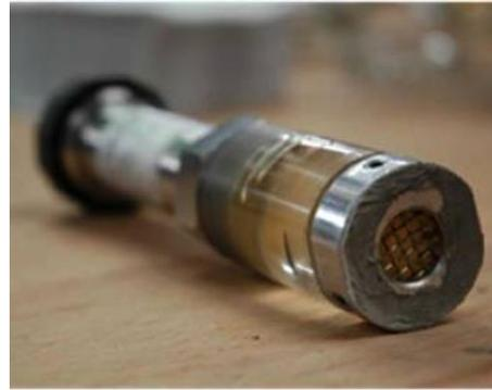
Abbildung 15: Drucksensor in Öl-Reservoir (Quelle: KAITNA).
