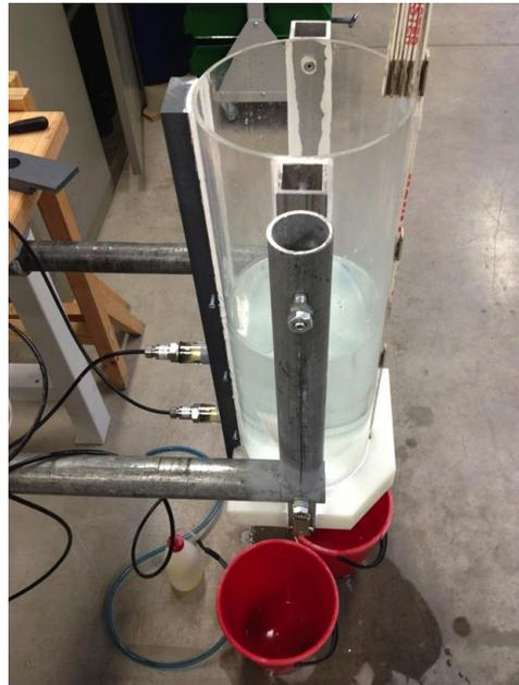
Abbildung 12: Versuchsanlage mit installierten Drucksensoren.
