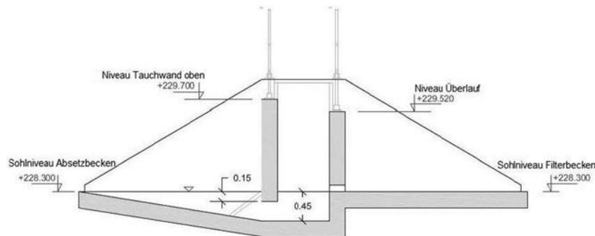
Abb. 4 Schematische Darstellung des Mönchs in ausgeführter Form (Kessler und Steurer 2012)
