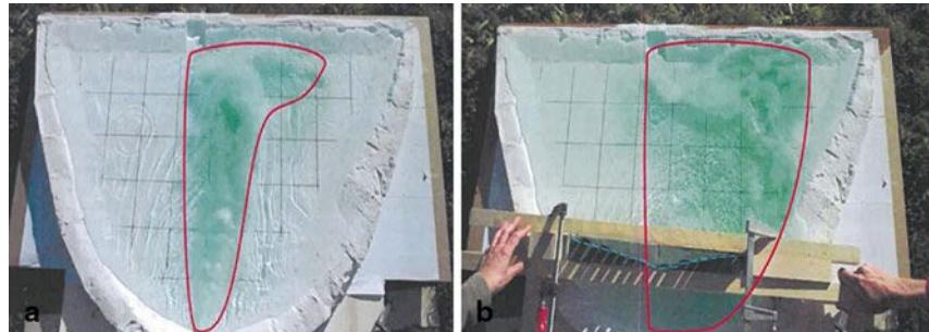
**Abb. 6** **a** Modellversuch vor Einbau des Rechens; Verweildauer Farbtracer im Modell 5 s (in Natur 35 s) und **b** Modellversuch mit Rechen; Verweildauer Farbtracer im Modell 11 s (in Natur 77 s) (Kessler und Steurer 2012)
