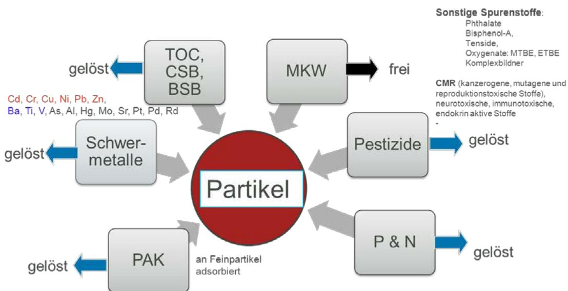
Abb. 1 Mögliche Verunreinigungen von Niederschlagsabflüssen
