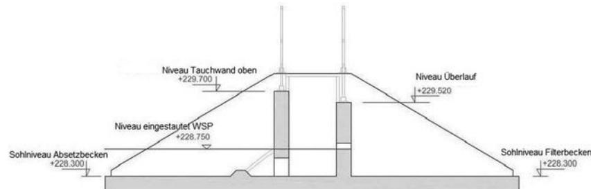
Abb. 3 Schematische Darstellung des Mönchs laut Planungsunterlagen
