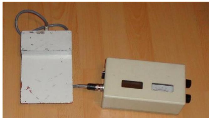
Abbildung 1-11: Denoth Meter mit Sensorplatte (links) und Rechen- bzw. Displayeinheit (rechts). (Foto: Martin Forster, 2014)
