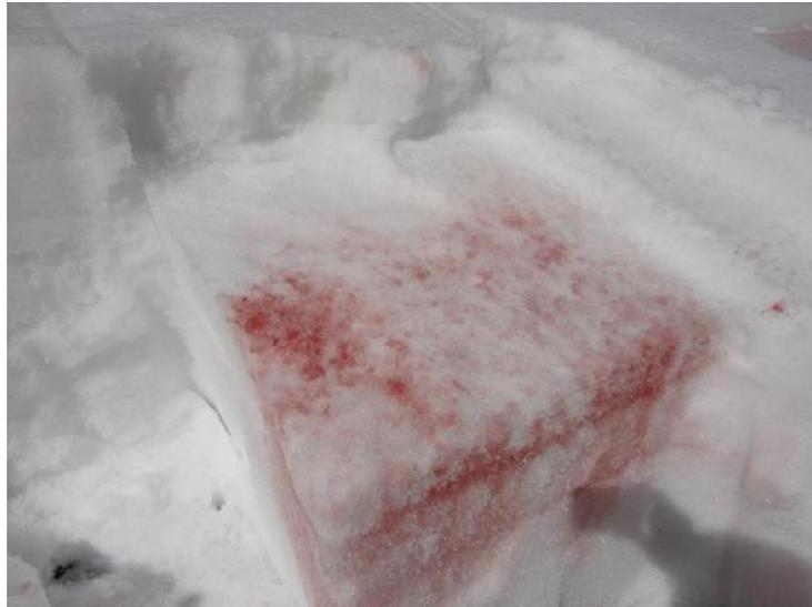
Abbildung 4-1: Größtenteils matrix flow, teilweise jedoch auch noch einzelne Fließkanäle zu erkennen. 3Liter Wasser wurden auf eine bereits feuchte Schneedecke aufgetragen (Versuch vom 20.3.2014, Foto: Martin Forster, 2014).
