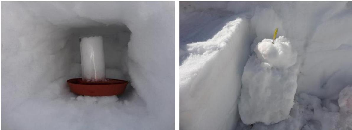
Abbildung 2-4: links: Behälter mit Schneeprobe in einer Höhle platziert um Temperatur- und Strahlungsverfälschungen zu verhindern; rechts: geschlossene Höhle (Fotos: Martin Forster, 2014)
