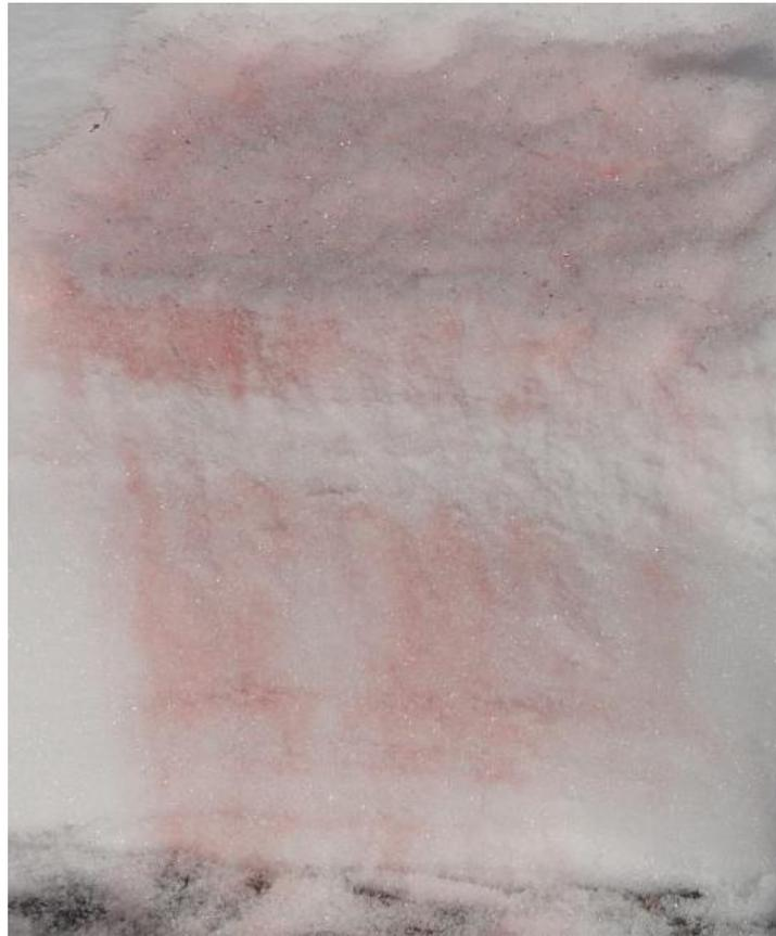
Abbildung 3-8: Das Bild zeigt die Profilwand des Blockes, der 2 Tage nach dem Färben freigeschnitten wurde. Die trockenste Schicht (weißer Streifen im oberen Drittel der Schneedecke) ist deutlich erkennbar. Ansonsten ist ein eindeutig matrixartiges Sickers zu erkennen. (Foto: Martin Forster, 2014)
