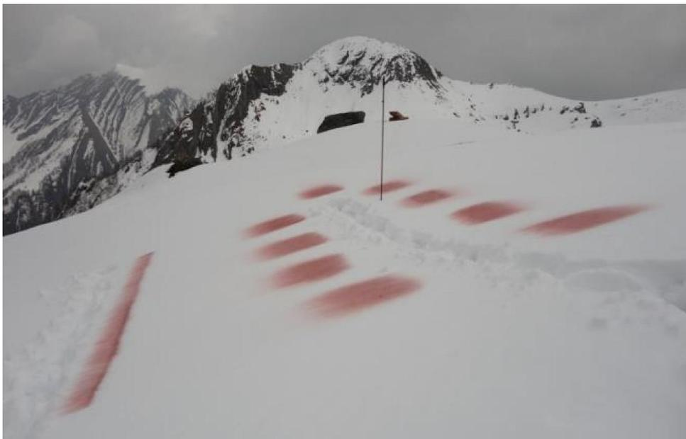
Abbildung 3-10: 9 Felder wurden direkt nebeneinander besprüht, um die Veränderung im Sickerfluss über die Zeit mitverfolgen zu können. (Foto: Martin Forster, 2014)
