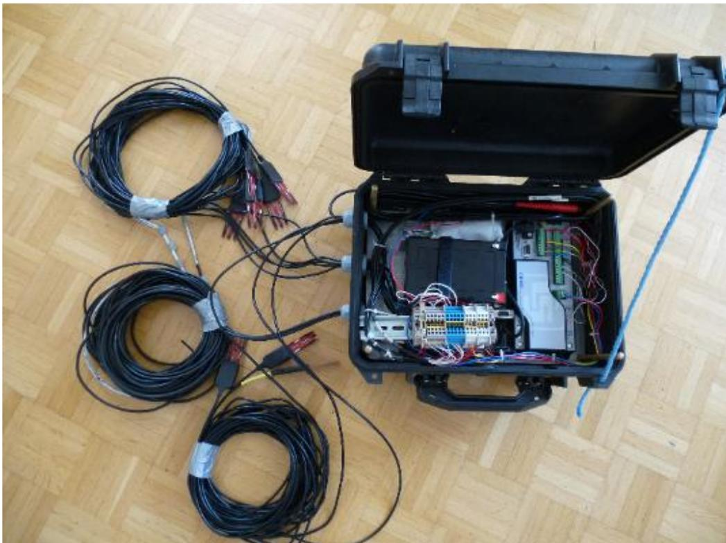
Abbildung 1-14: PeliCase mit Datenlogger, Batterie und Modem (nicht sichtbar), sowie Feuchtigkeits- und Temperatursensoren (Foto: Markus Zöchling, 2014)
