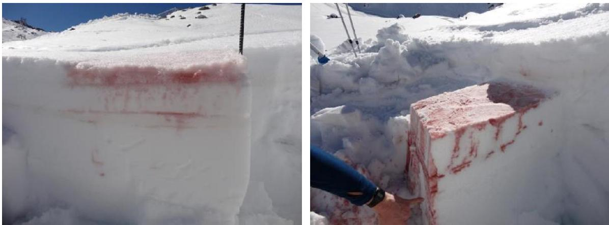
Abbildung 3-5: Bild links: Es ist zu erkennen, dass der Schnee bis zur ersten Eisschicht flächig vollgesogen ist, unter dieser Eisschicht ist deutlich die Ausbildung von Fließkanälen bis zur nächsten Eisschicht ersichtlich. Bild rechts: der obere Deckel der Schneedecke wurde bis direkt unter der zweiten Eisschicht abgehoben und darunter neu begossen. Es ist ein eindeutig kanalisierter Sickerprozess zu erkennen. Es handelte sich um 1-2 mm große Schmelzformen. (Fotos: Martin Forster, 2014)
