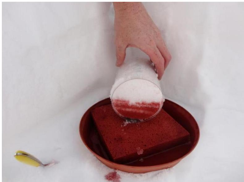
Abbildung 3-16: Auf dem Bild zu sehen ist eine Probe, die direkt an der Schichtgrenze zwischen einer kantigen und einer Schicht aus kleinen Runden Kristallformen horizontal ausgestochen wurde. Die rot gefärbte Schicht besteht aus kleinen Runden, die weiße Schicht aus kantigen Kristallen. (Foto: Martin Forster, 2014)
