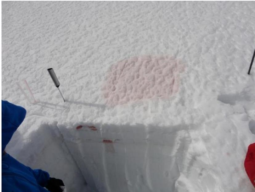
Abbildung 3-13: Schichtparalleler Wasserfluss. Die Hangneigung der Versuchsfäche betrug  $9^\circ$ . Das Wasser kann die Eislamellen, die sich nahe der Oberfläche der Schneedecke befinden, nicht, oder nur punktuell durchdringen. Ein großer Teil des Wassers bewegt sich daher hangparallel von der Versuchsfäche weg. (Foto: Martin Forster, 2014)
