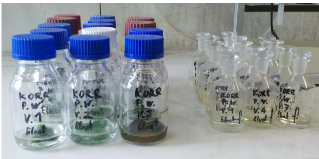
Abbildung 9: Eluat und Filtrat der Vliesproben (selbsterstellt)
