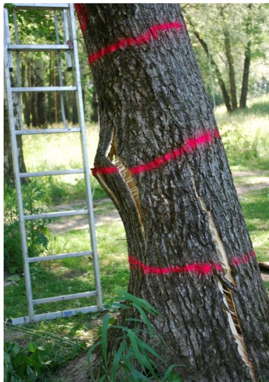
Abbildung 71: Nach dem Riss war ein Knicken der Rinde im Druckbereich zu sehen und hören, Baum 6: *Populus x canadensis*, Aubad Tulln, Juni 2014.
