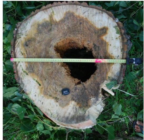
Abbildung 26: Schnitt des Baumstammes in 50 cm Höhe. Das deutlich verfärbte Holz rund um die Höhlung wird in der Schalltomographie als intakt dargestellt, Baum 1: *Populus x canadensis*, Aubad Tulln, Juni 2014.
