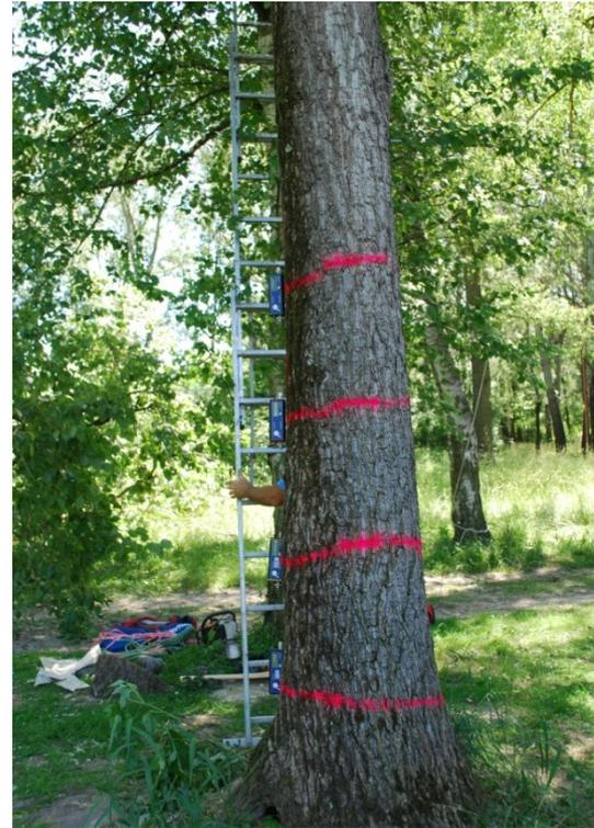
Abbildung 63: Anordnung der Geräte am Baum in 50 cm Abständen. Mit einer Leiter wurde das obere Inclinometer in 6 m Höhe angebracht, Baum 6: *Populus x canadensis*, Aubad Tulln, Juni 2014.
