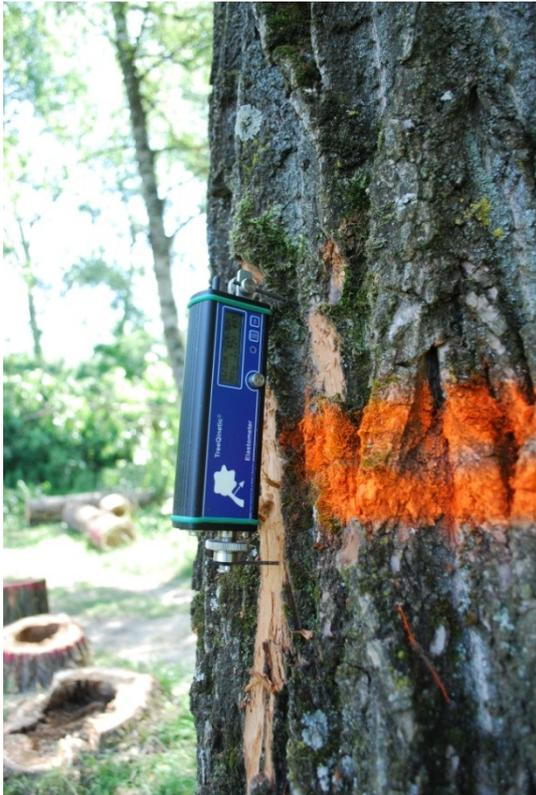
Abbildung 43: Elastometer am Stamm montiert, *Populus x canadensis*, Aubad Tulln, Juni 2014.
