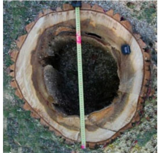
Abbildung 39: Schnitt des Baumstammes in der Höhe von 50 cm. Es ist eine sehr große Übereinstimmung mit dem Bild der Schalltomographie zu sehen, Baum 3: *Populus x canadensis*, Aubad Tulln, Juni 2014.
