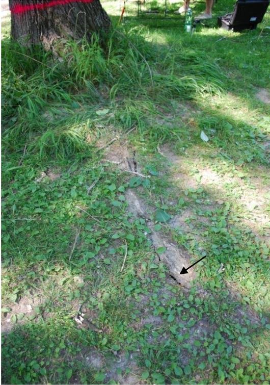
Abbildung 29: Während des Zugversuches waren neben dem rasch steigenden Neigungswinkel des unteren Inclinometers auch deutlich Risse und Geräusche im Boden – auf der Zugabgewandten - zu vernehmen, Baum 1: *Populus x canadensis*, Aubad Tulln, Juni 2014.
