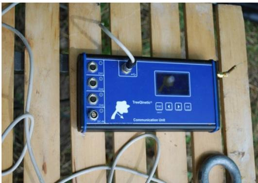
Abbildung 67: Die Basisstation bekommt die Messdaten der Geräte über Funk und überträgt sie zu einem Computer der sie aufzeichnet, Aubad Tulln, Juni 2014.
