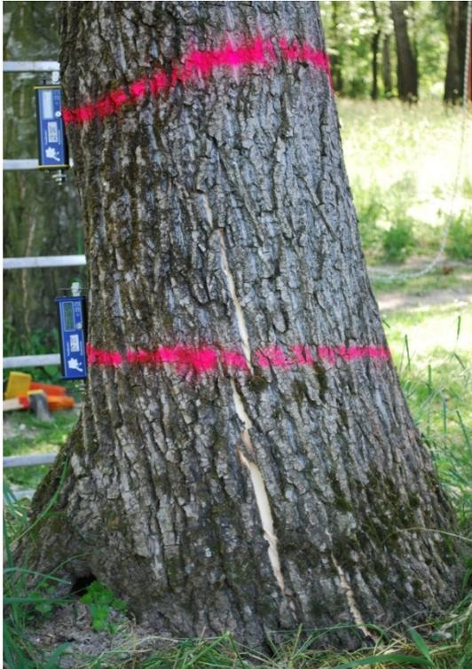
Abbildung 69: Auch bei Baum 6 bildeten sich seitlich Risse während des Versuches, welche jedoch erst nach dem gemessenen Primärversagen sichtbar wurden, *Populus x canadensis*, Aubad Tulln, Juni 2014.
