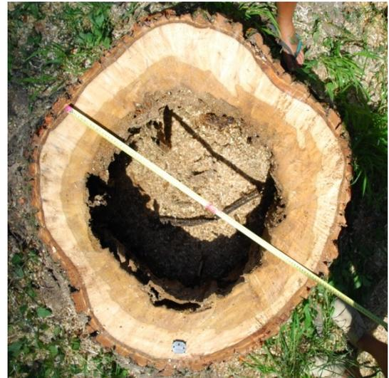
Abbildung 48: Schnitt des Baumstammes in der Höhe von 50 cm. Eine recht gleichmäßige Zersetzung ist zu erkennen, Baum 4: *Populus x canadensis*, Aubad Tulln, Juni 2014.
