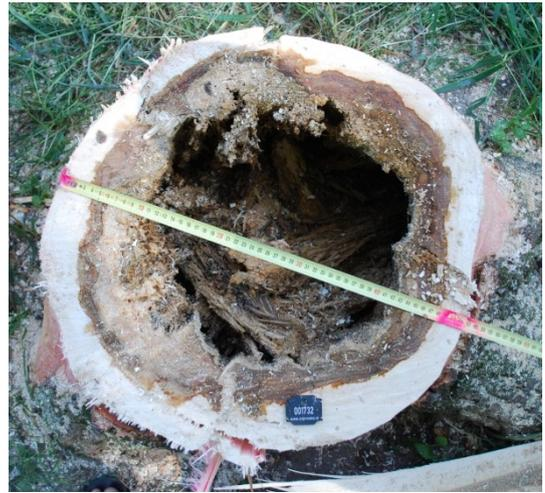
Abbildung 65: Schnitt des Baumstammes in der Höhe von 50 cm. Der hohe Zersetzungsgrad des Holzes rund um die Höhlung konnte in der Schalltomographie nur erahnt werden, Baum 6: *Populus x canadensis*, Aubad Tulln, Juni 2014.
