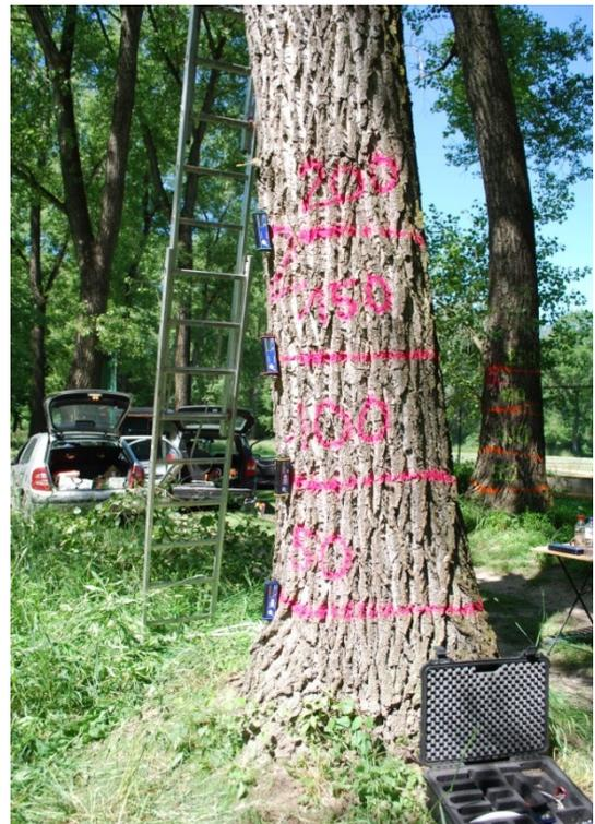
Abbildung 32: Anordnung der Geräte am Baum in 50 cm Abständen. Eine angelehnte Leiter zur Befestigung des Inclinometers in 6 m Höhe, *Populus x canadensis*. Aubad Tulln. Juni 2014.
