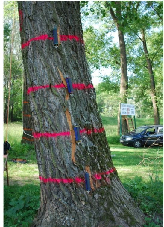
Abbildung 55: Anordnung der Geräte am Baum in 50 cm Abständen. Teile der Borke wurden entfernt um die Geräte besser anbringen zu können, Baum 5: *Populus x canadensis*, Aubad Tulln, Juni 2014.
