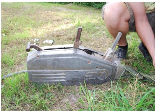
Abbildung 20: Mit einer Handseilwinde wurde teilweise bis zum Baumbruch gezogen, Aubad Tulln, Juni 2014.
