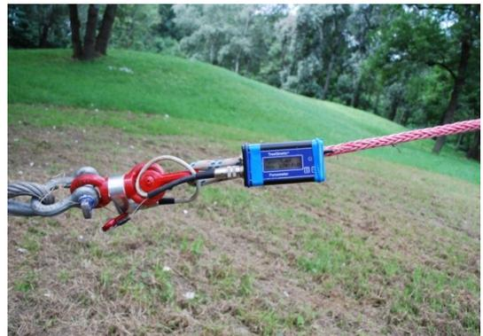
Abbildung 14, 15: Forcemeter während eines Zugversuches zwischen zwei Seilen montiert, Aubad Tulln, Juni 2014.
