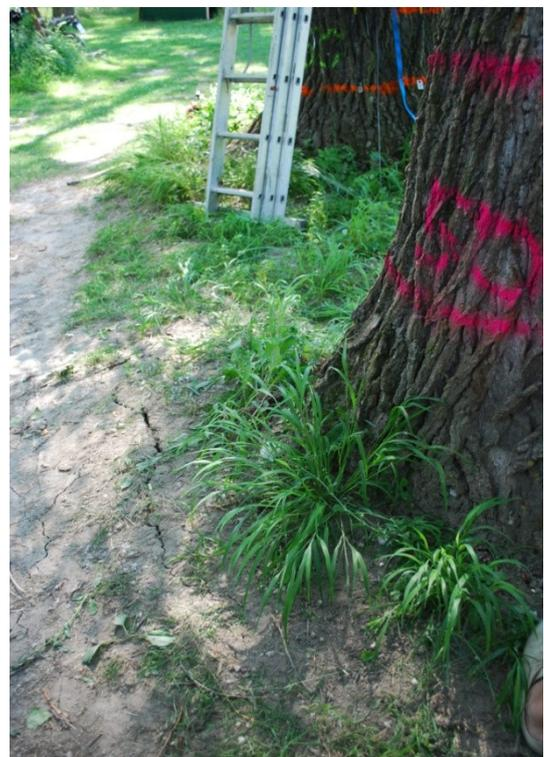
Abbildung 42: Risse im Boden während des Zugversuches lassen eine Entwurzelung vermuten, Baum 3: *Populus x canadensis*, Aubad Tulln, Juni 2014.
