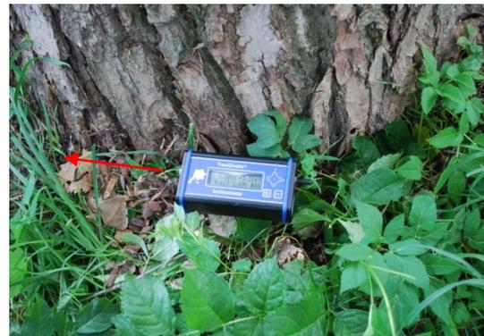
Abbildung 58: Die Ausrichtung des Inclinometers in Zugrichtung, *Populus x canadensis*, Aubad Tulln, Juni 2014.
