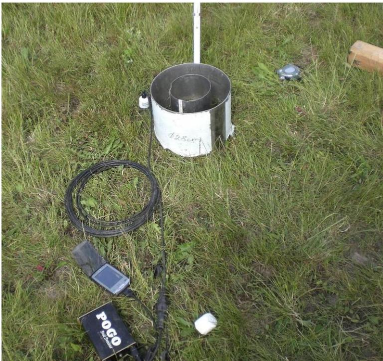
**Abb. 41: DR-Versuch – Messung Wassergehalt**
