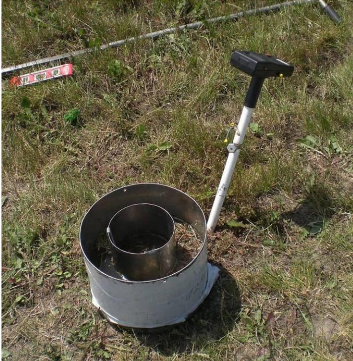
**Abb. 40: DR-Versuch mit eingebautem Tensiometer**
