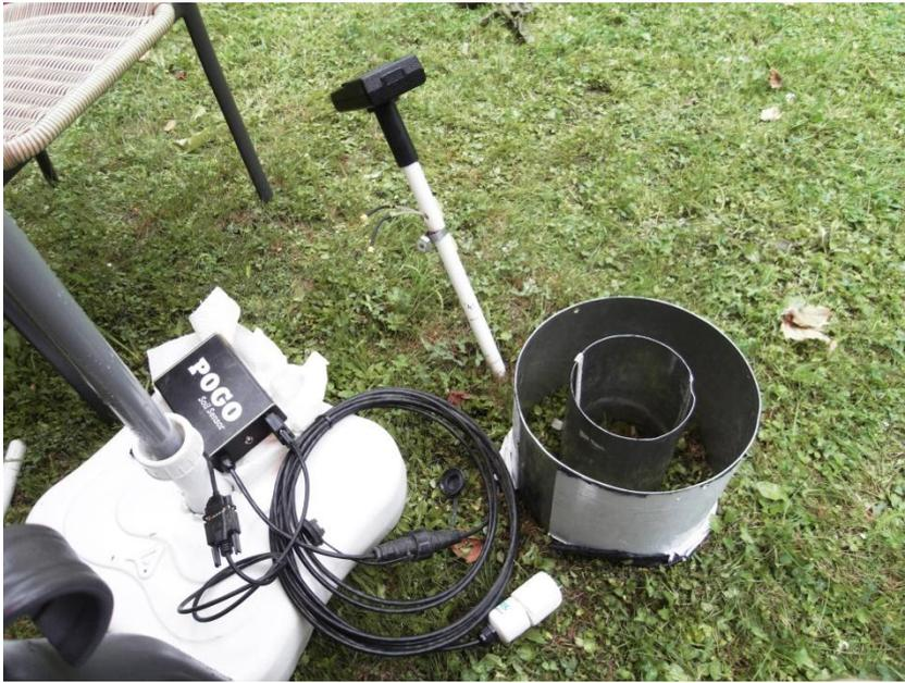
Abb. 214: DR-Versuch mit eingebautem Tensiometer
