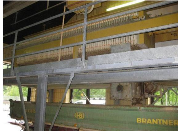
Abbildung 25 Kammerfilterpresse
