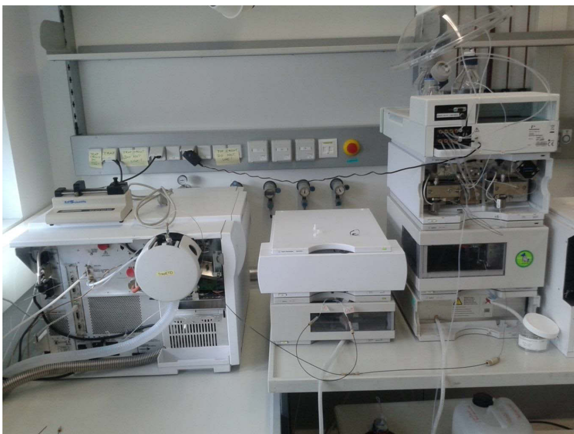
Abbildung 4: Für die Analyse verwendete Ionenfalle Agilent 6340 mit HPLC.
