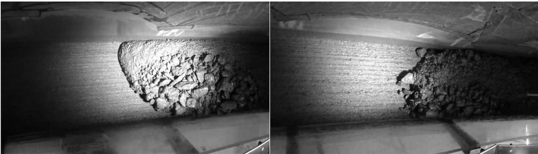
**Abbildung 34: Ansicht der Trommelrinne. Einseitige Aggregation der Grobkomponenten bei fb3\_1\_v2 (links) und fb3\_1\_v3 (rechts).**
