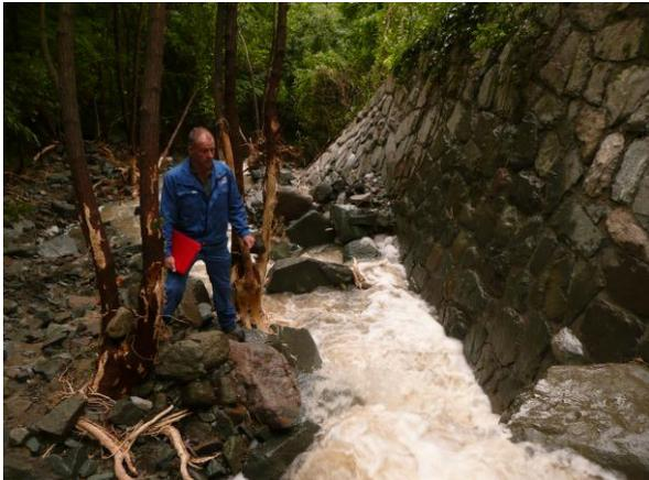
Abbildung 3.20: Abgeschälte Bäume und Wurzeln, Anschlagmarke 1,80 m, bei hm ~1,38 (28), Aufnahme- datum 01.09.2014 (Philipp Walder).
