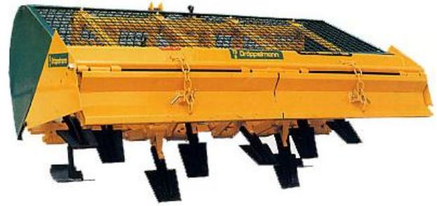
**Abbildung 32: Spatenmaschine (BTB Baumschultechnik und Beratung GmbH, 2015).**
