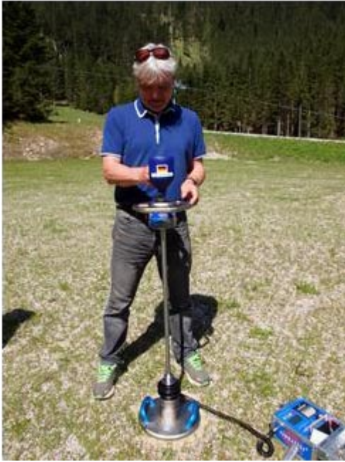
Bild 39: Gerätschaft zur Durchführung eines dynamischen Lastplattenversuches
