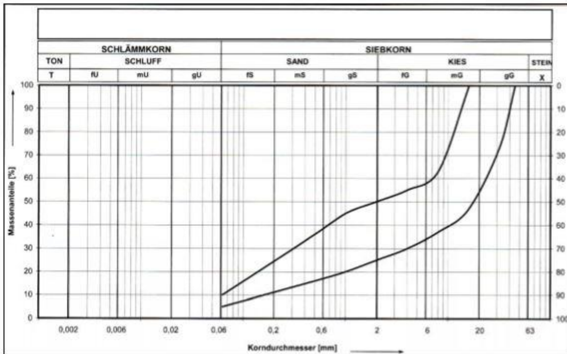
Abbildung 3: Sieblinie der Materialzusammensetzung für Schotterterrassen (Quelle: FLL 2008, 22)
