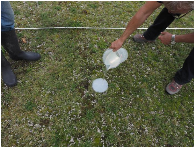
Bild 40: Ausschüttversuch nach Pregl
