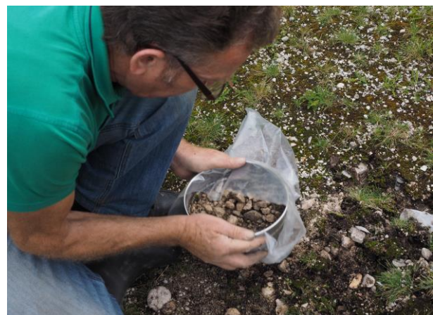
Bild 43: Sieben der Bodenproben
