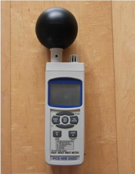
Abbildung 3.5: Hitzestressmessgerät
