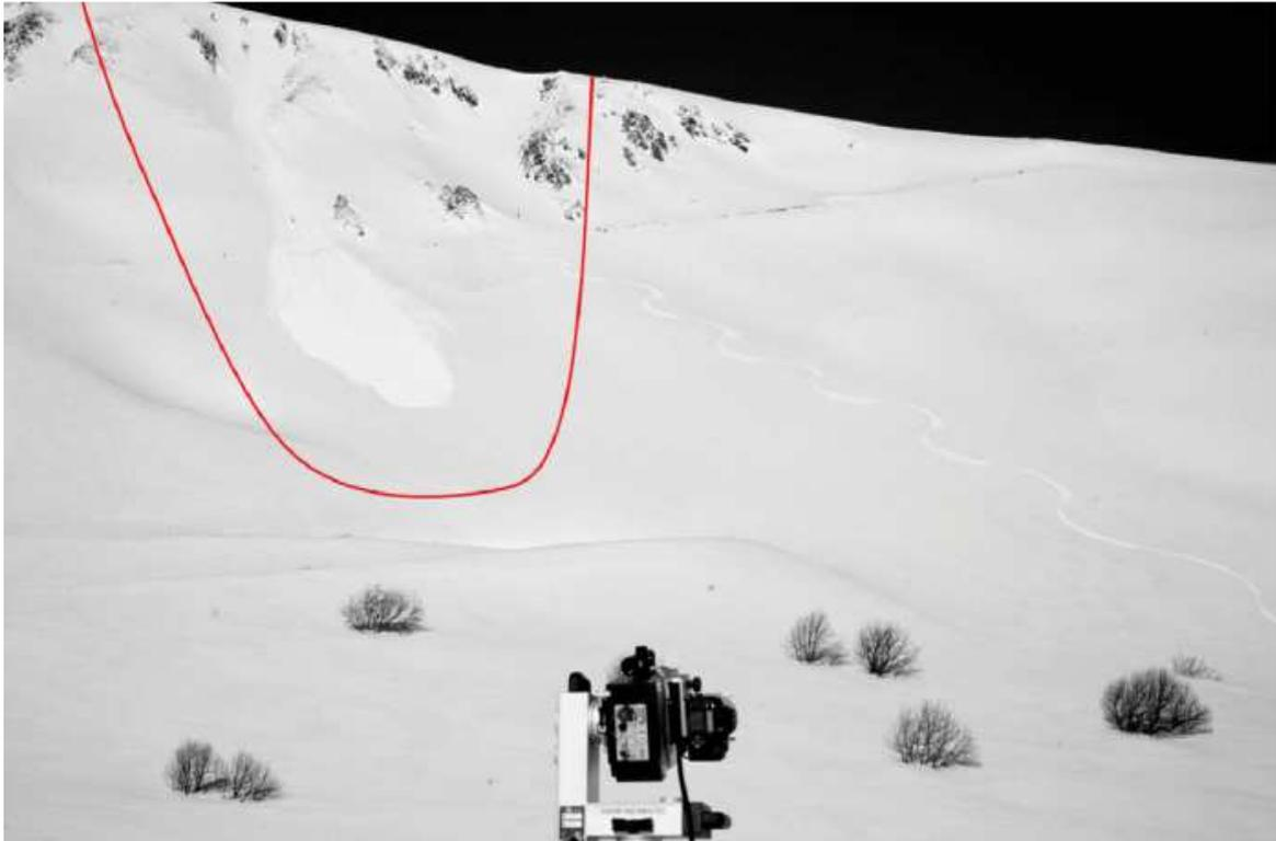
Abbildung 14: Der LPM-321 und die zu untersuchende Lawine am Col du Lautaret, die am 13. Februar 2013 ausgelöst wurde; die zu scannende Fläche ist durch die rote Linie eingegrenzt. (Prokop, et al., 2013)
