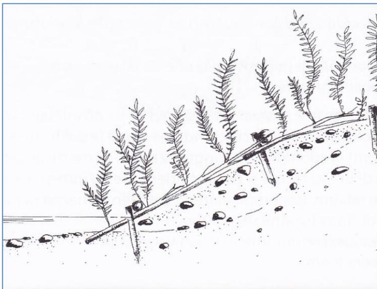
Abbildung 24: Spreitlagenbuhne mit ausgetriebenem Weidenmaterial (ZEH, 2007)
