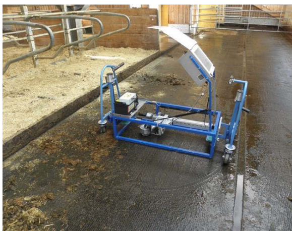
Abbildung 21 und 22: Gleitmessgerät GMG08 der ART in Tänikon und dazugehörige Monitoranzeigen mit Messort, Produkt, Reinigungsbedingungen, Messstrecke und Messfahrt.
