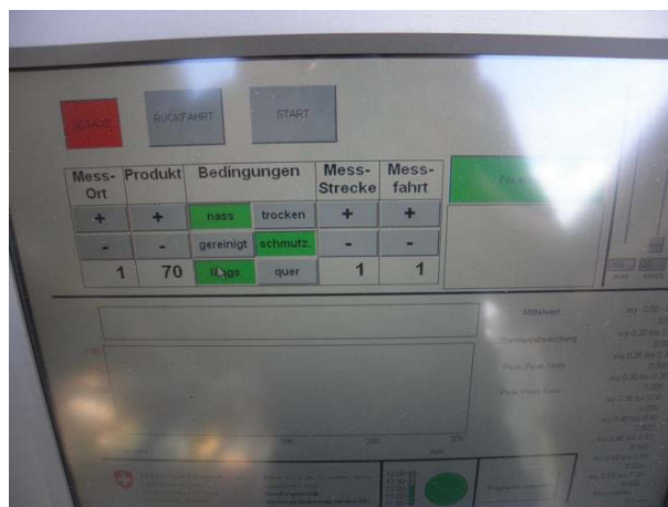
Abbildung 21 und 22: Gleitmessgerät GMG08 der ART in Tänikon und dazugehörige Monitoranzeigen mit Messort, Produkt, Reinigungsbedingungen, Messstrecke und Messfahrt.
