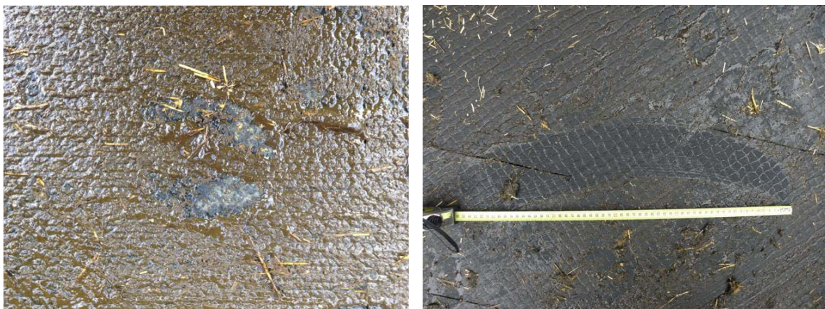
Abbildung 26 und 27: Einzelner Tritt und Abmessen einer Rutschung (54 cm).
