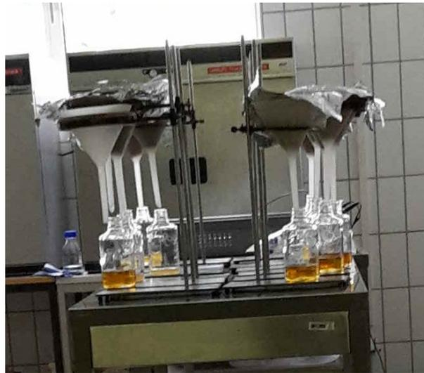
Abbildung 4.2: Filtration des Heißwasserextraktes
