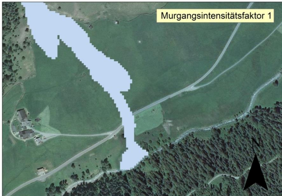
Abbildung 8.23: Modelliertes Murgangs-Szenario mit einem Murgangsintensitätsfaktor von 1.
