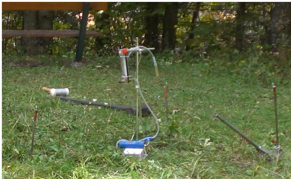
Abbildung 4.4.: Der Aufbau zur Messung der Permeabilität.
