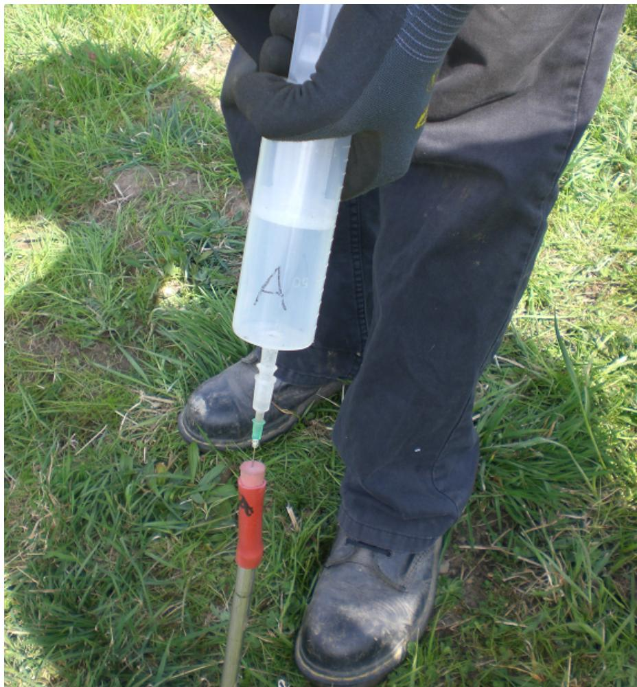
Abbildung 4.2.: Aus der Messsonde wird über den Adapter mit einer Spritze die Luft ausgesogen.
