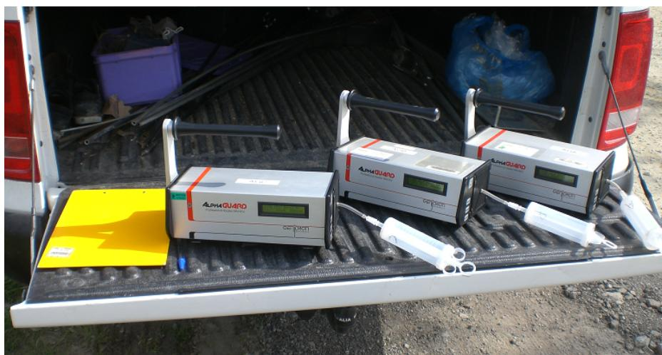
Abbildung 4.3.: AlphaGUARDs mit angesteckten Spritzen während einer Messung.
