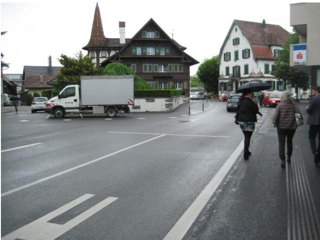
Abbildung 4.4-5: Seitenbereich mit taktilem Blindenleitsystem
