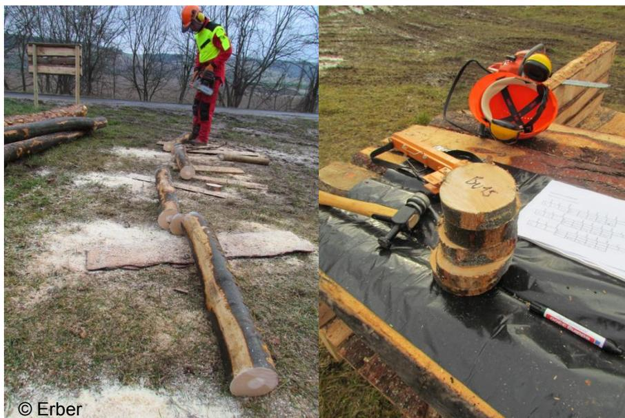
**Abbildung 7: Stammscheibenentnahme für die Laboranalyse.**
