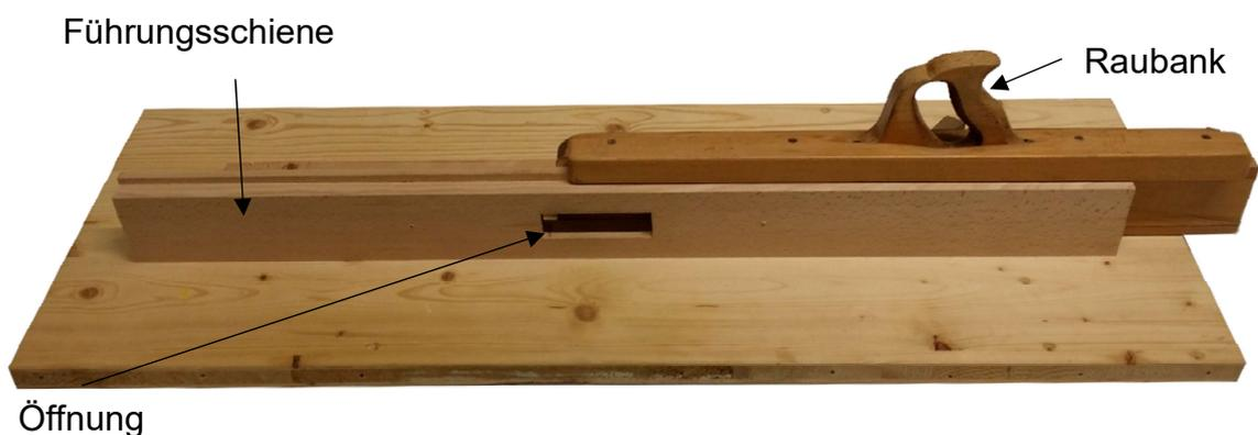
Abbildung 21: Für die Spanabnahme modifizierte Raubank
