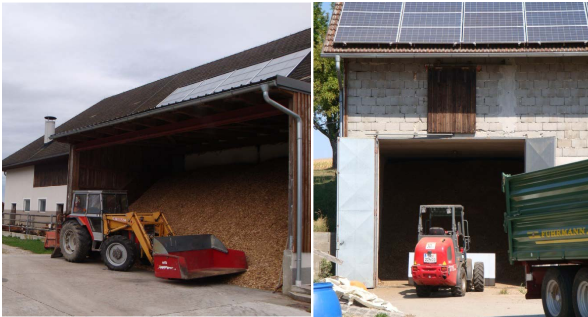
Abbildung 19: Die am häufigsten verwendeten Manipulationsmittel für das Hackgut sind Teleskopklader (oben) und Traktoren mit Frontladern (unten links). Weniger oft kommen Hub-/Gabelstapler (unten rechts) zum Einsatz. Für das Einlagern, Belüften und/oder Wenden sowie Auslagern ist ein Zeitaufwand von knapp zwei Stunden pro Charge anzusetzen
