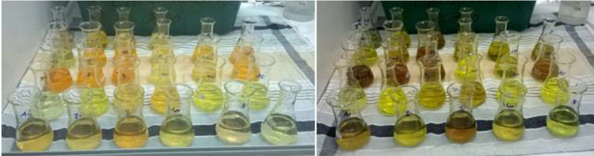
Abb. 17: Aufbereitung der Extrakte zur Messung des Gesamtzuckers (li) nach der Hydrolyse im Wasserbad; (re) nach Zugabe von NaOH
