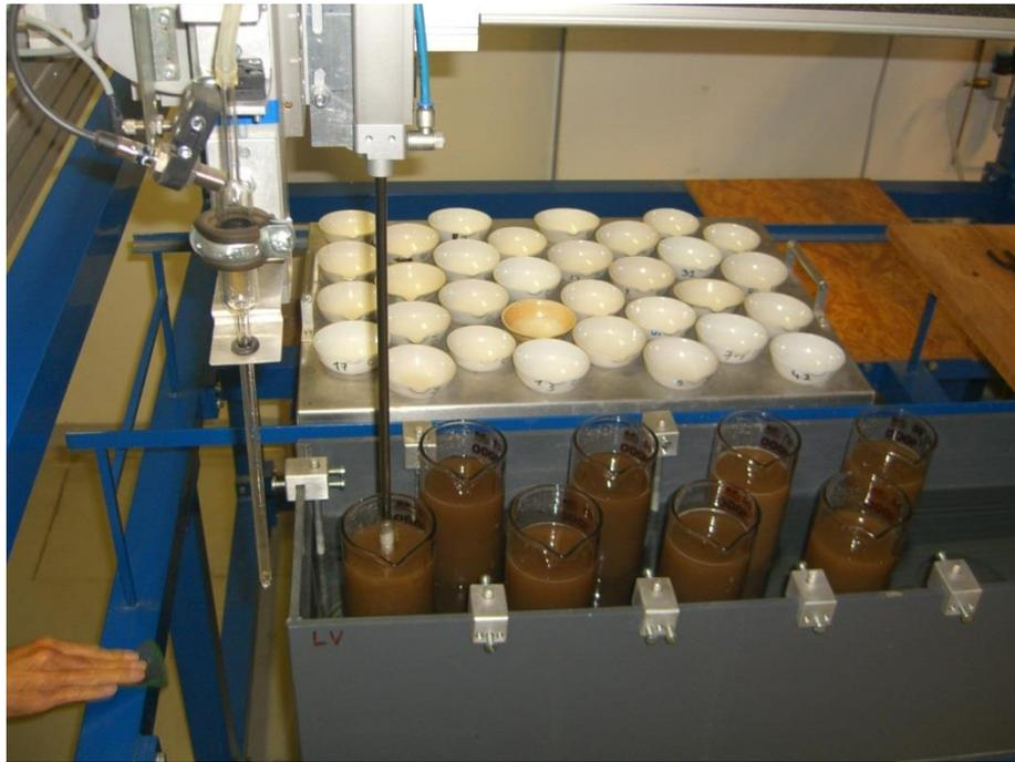
**Abbildung 14:** Automatisierte Pipettieranlage des IHLW.
