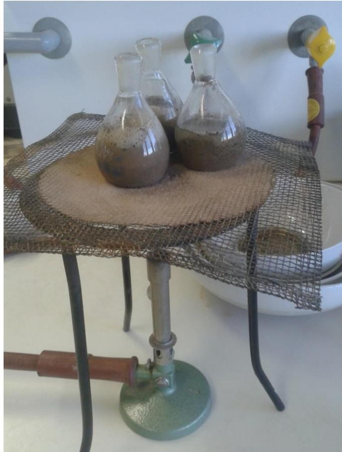
**Abbildung 13:** Aufkochen der Suspension im Pyknometer mithilfe des Bunsenbrenners.
