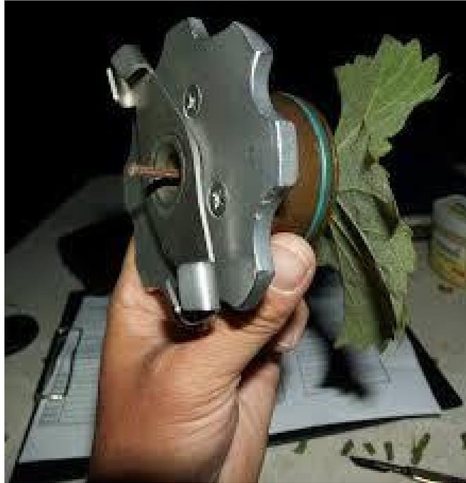
**Abbildung 8:** Einspannung des abgeschnittenen Blattstielendes in Bajonettverschluss der Scholanderdruckkammer (nach Gabler und Kühner 2014).
