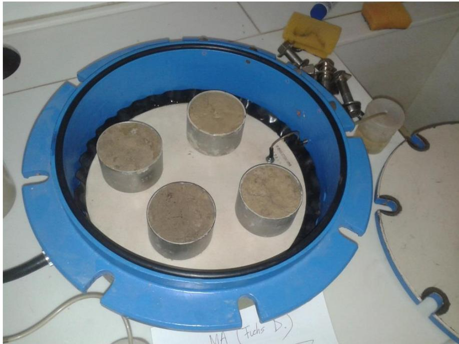
**Abbildung 16:** Druckplattenapparat.
