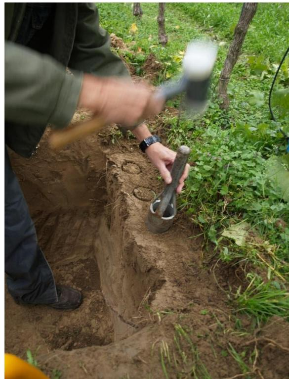
**Abbildung 12:** Bodenprofilgrube (linke Seite) und Einbringen der Stechzylinder (rechte Seite).
