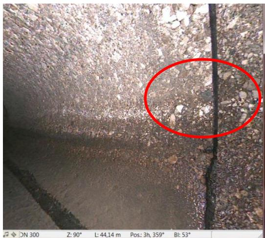
Abbildung 232: Beton DN300, Scan-System 2 3D, Riss, 4mm
