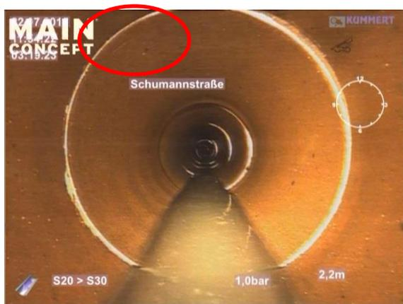
Abbildung 213: TV-Kamera 3, Riss, 1mm
