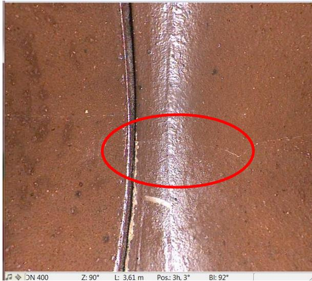
Abbildung 210: Scan-System 2 3D, Riss, 2mm
